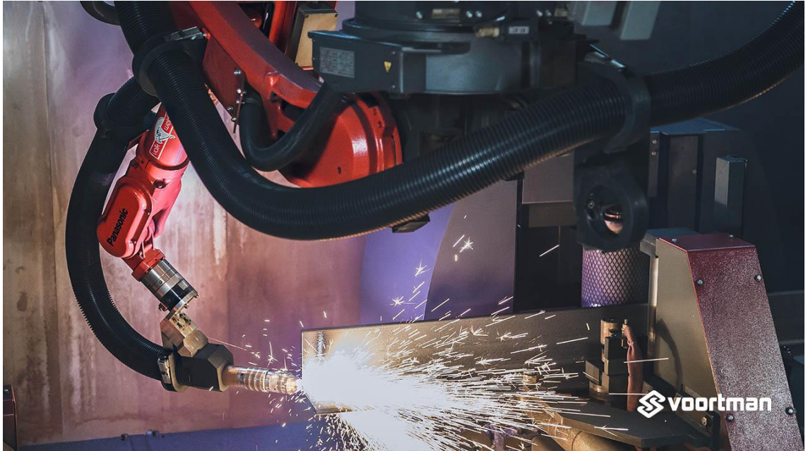
Kuva 6 Aukotusrobotti (Voortman verkkosivut 2018)
