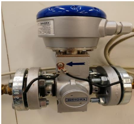
Kuva 11. Mittauksissa käytetty Krohne Optiflux 4000F -vesimittari.
