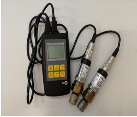
Kuva 12. Danfoss RA-DV -patteriventtiin mittauksissa käytetty Tecsis Manoport 3094 -paine-eromittari.
