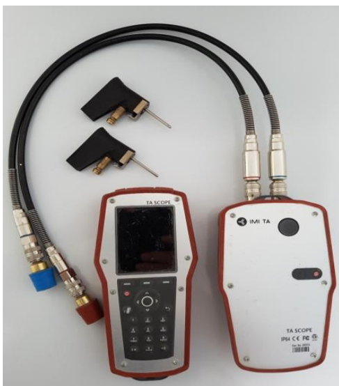
Kuva 13. IMI TA Eclipse -patteriventtiin virtausmittauksissa käytetty IMI TA Scope -paine-eromittari [13, s. 11].
