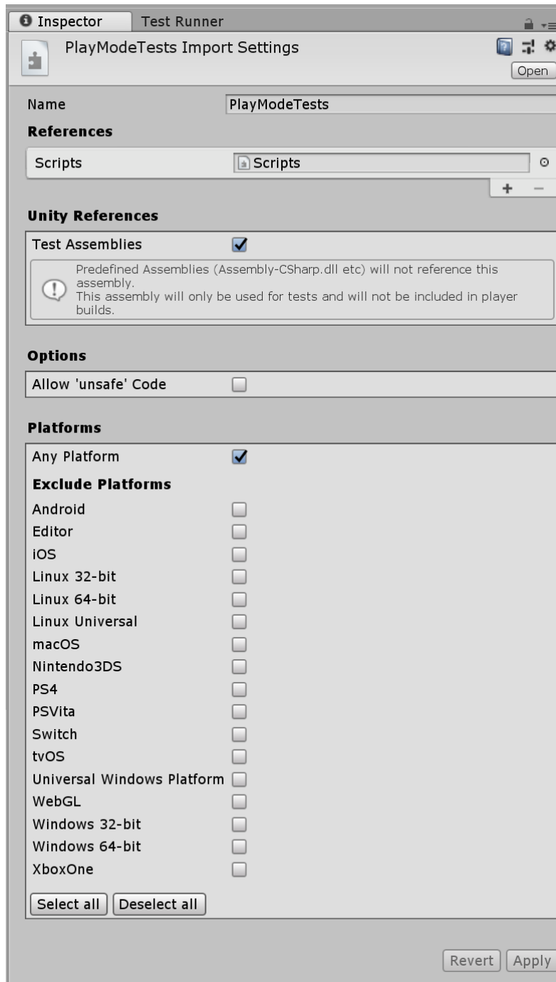
Kuva 4. Esimerkki Assembly Definition -tiedoston asetuksista konfiguroituna testiskriptejä varten.
