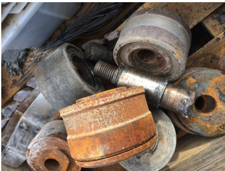
Kuva 4. Vuosihuollon aikana vaihdettuja arinalaakereita
