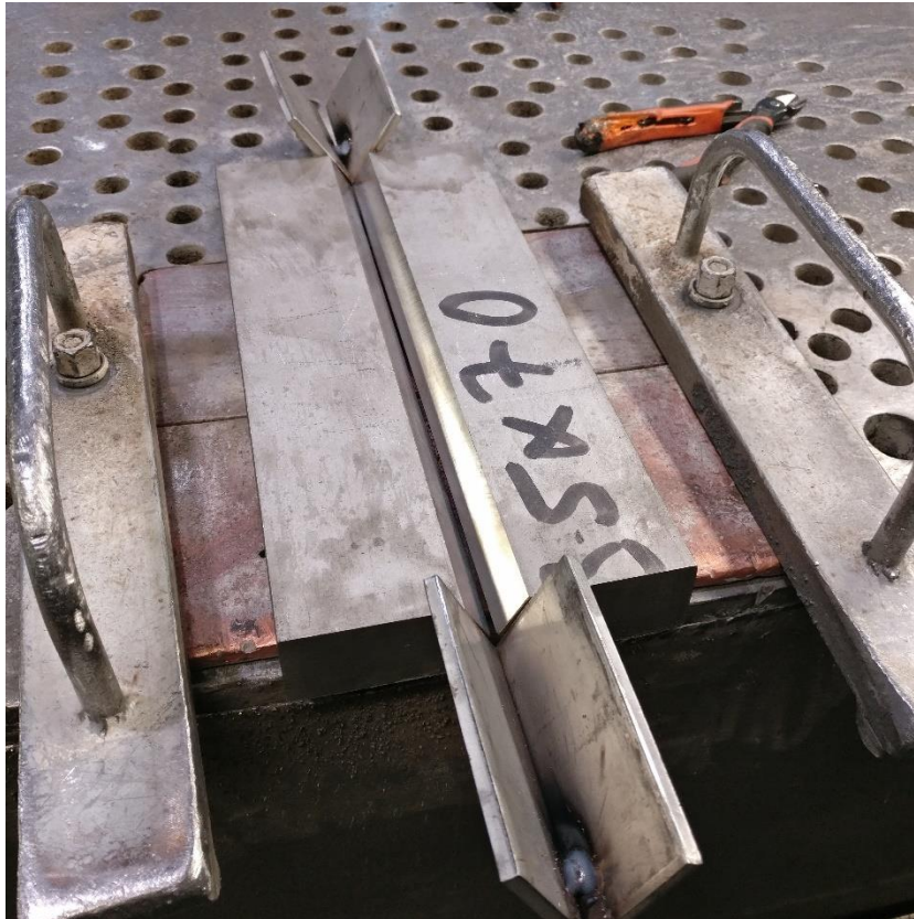
Kuva 13. Pätevyyskokeen koekappaleen asettelu
