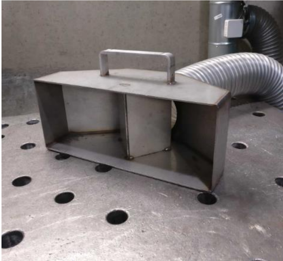
Kuva 17. Pölynpoistojärjestelmään liitetty imulaatikko
