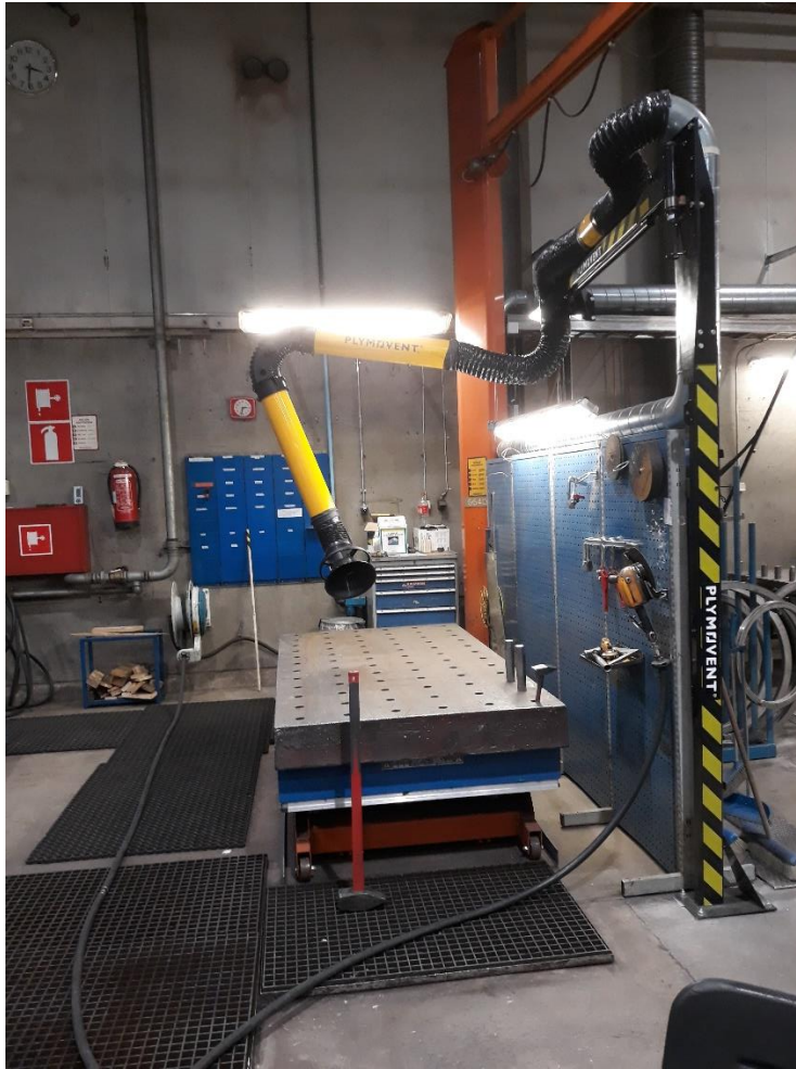
Kuva 16. Renkaan katkaisun aikana käytettävä kohdepoisto
