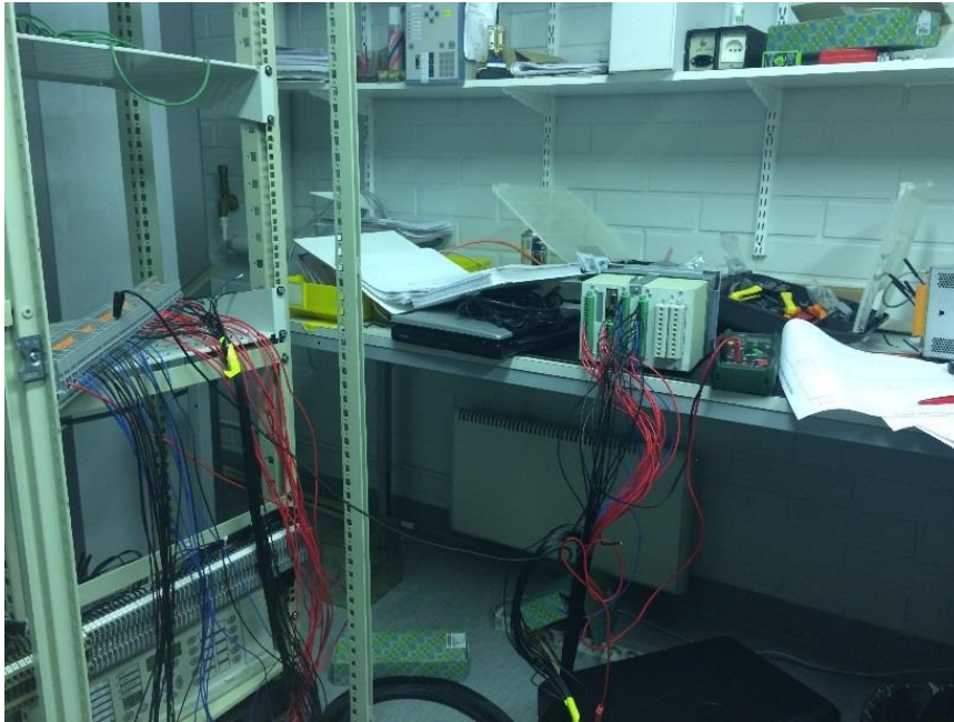
Kuvio 10 Liityntäraajapinnan ja suojareleen väliset kytkennät varmistettiin mittamalla.
