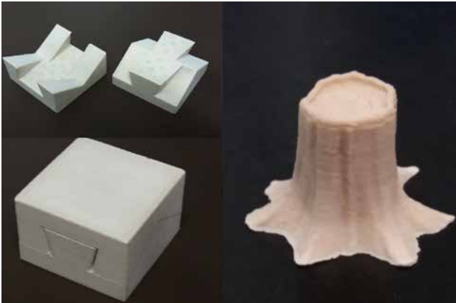
KUVA 2. Puufilamentti UPM Formi 3D -tulostuskäytössä: vasemmalla japanilainen puulii-tos ja oikealla ”komposiittikanto” (kuva Ilkka Vanttaja).
