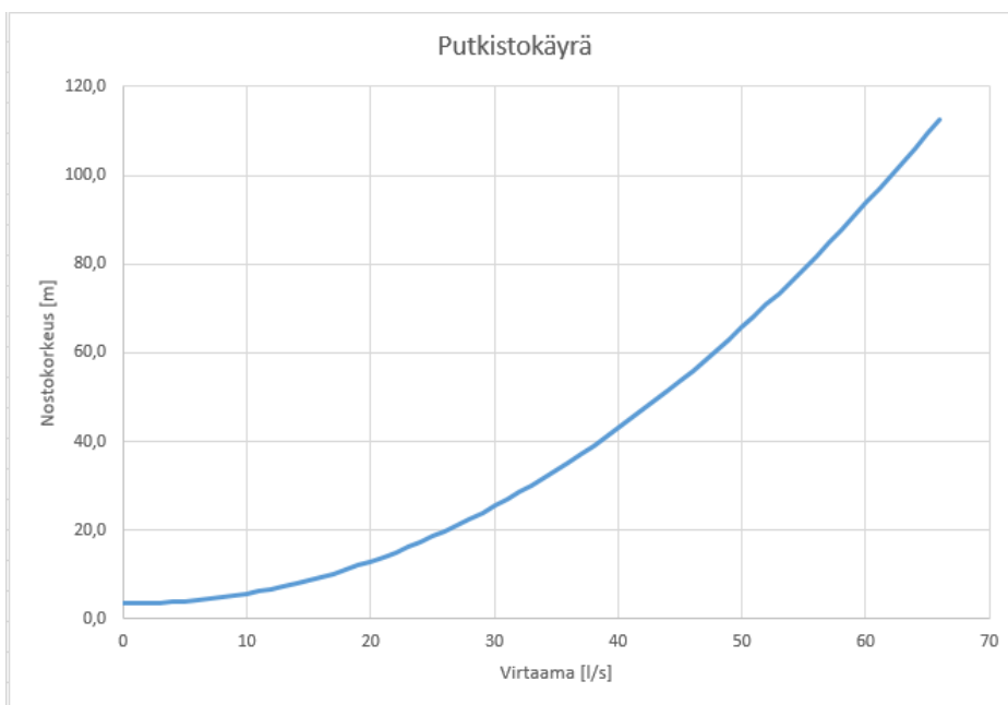
KUVA 1. Erään jätevesilinjan putkistokäyrä.
