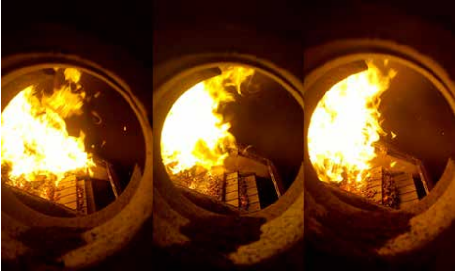
KUVA 1. Vasemmalla puupellettien poltto, keskellä hevosenlantakutteripelletti-puupellettiseoksen poltto ja oikealla hevosenlantaturvepelletti-puupellettiseoksen poltto Ariterm Oy:n BioComp 120 -kattilassa (kuva Riina Tuominen).
