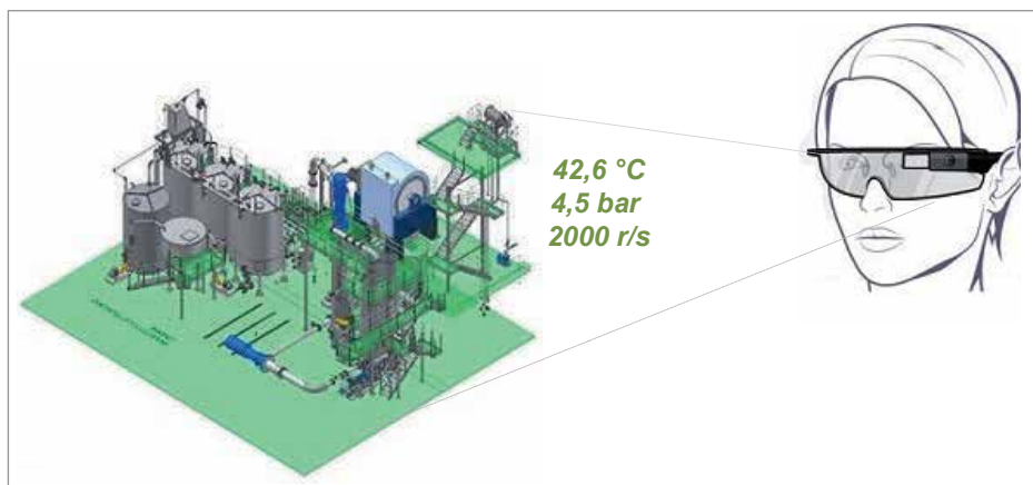
KUVA 2. Digital Twins- jaltai 3D/AR+VR-teknologioiden hyödyntäminen seurannassa, laitehuollossa sekä esimerkiksi laitteistojen esittelyssä (kuva Xamk).
