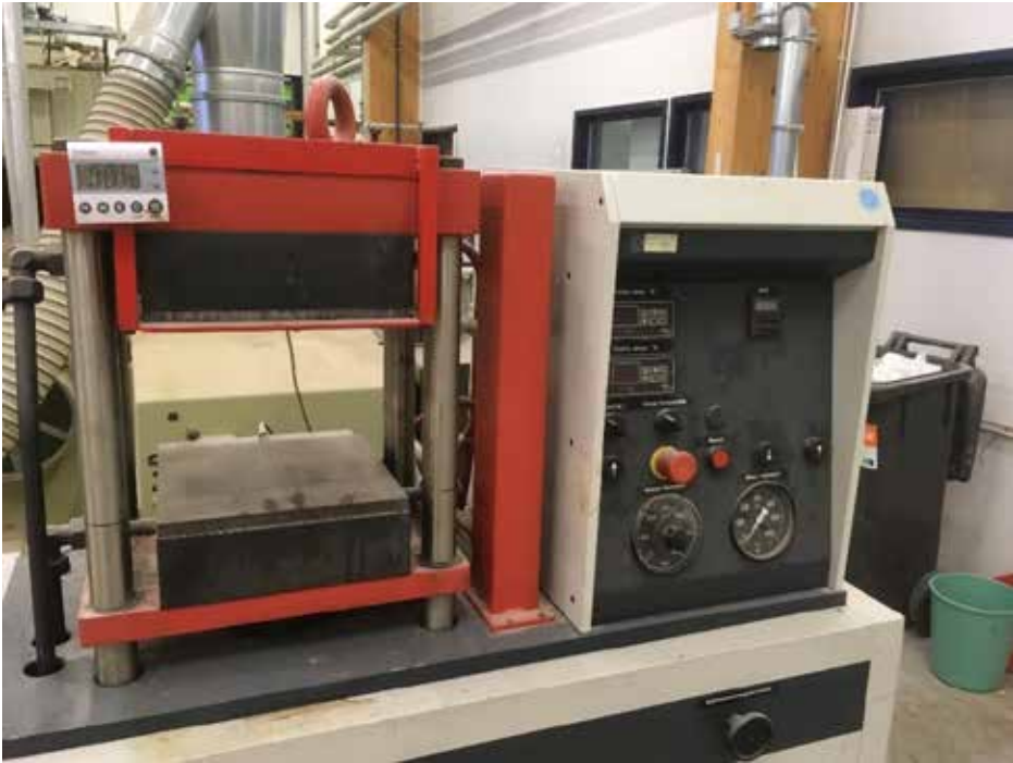
KUVA 3. Laboratoriomittakaavan puristin, jolla tehtiin osa koelevyistä (kuva Olli Paajanen).
