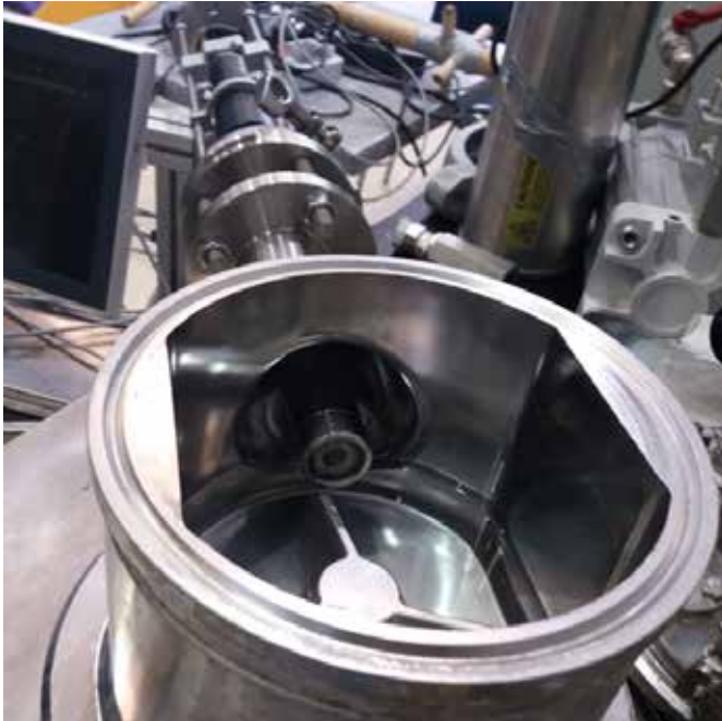
KUVA 5. Karbonaattoreaktori, johon on yhdistetty kuplakuvauslaitteisto (kuva Jari Käyhkö).
