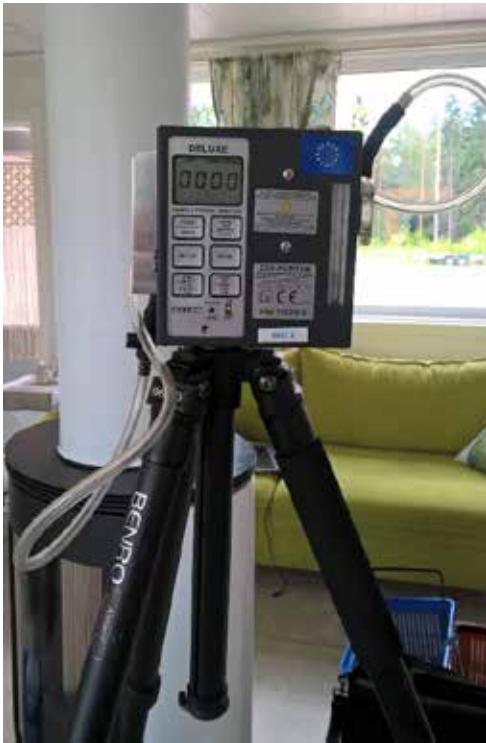
KUVA 8. Näytteenotto pumpulla Tenax TA -putkeen (kuva Salla Thil 2018).
