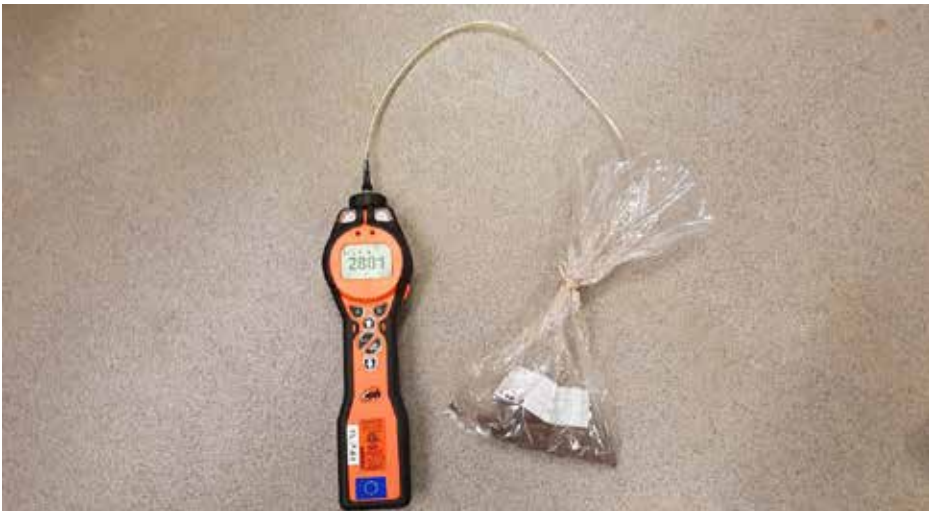
KUVA 1. VOC-yhdisteiden mittaus maanäytteestä PID-mittarilla (kuva Marjatta Lehesvaara).
