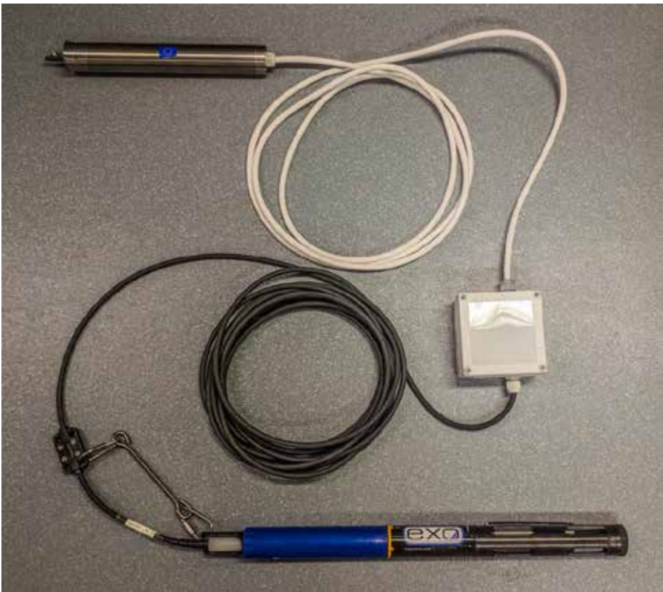
KUVA 2. Monitorointiaseman laitteisto. Ylhäällä ARC-1-lähetinyksikkö, keskellä signaalinmuuntaja sekä alimpana EXO-1-vedenlaatusondi (kuva Aki Mykkänen).
