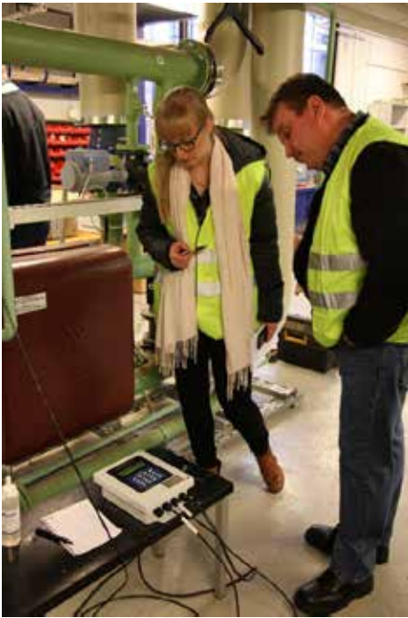
KUVA 3. Uuden virtausmittarin testaamista, kuvassa projektipäällikkö Erja Tuliniemi ja energiatekniikan lehtori Marko Saxell (kuva Eveliina Kuokkanen).
