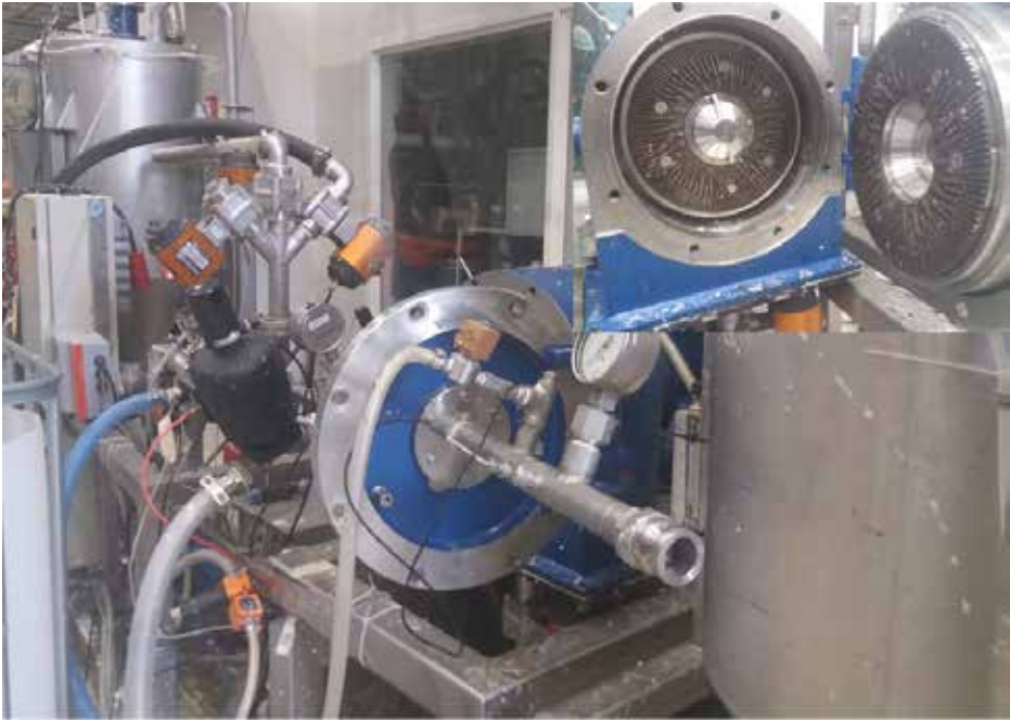
KUVA 3. Kokeissa käytetty pilot-levyjauhain (kuva Jari Käyhkö).
