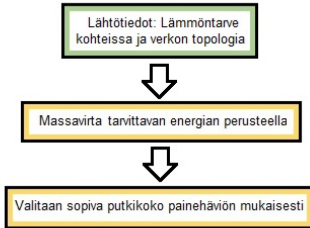
KUVA 1. Lämmitysverkon mitoituksen vaiheet (kuva Teemu Karttaavi).
