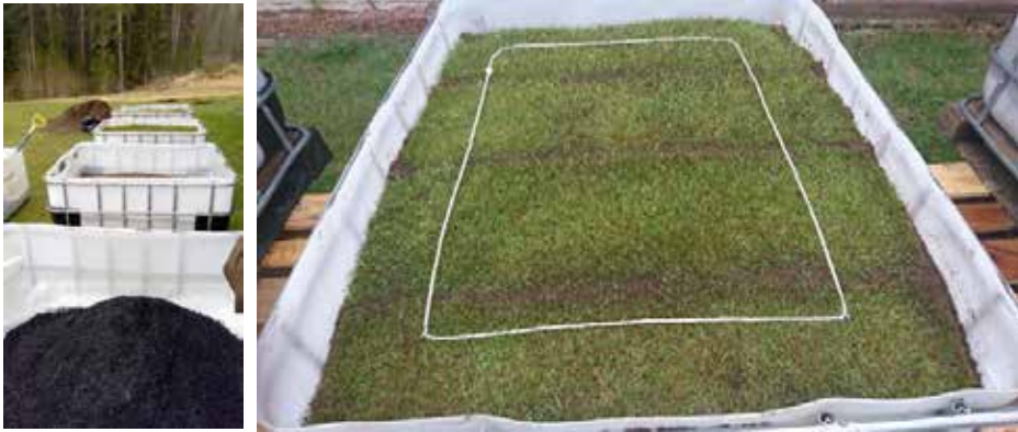
KUVA 1. Alustat muokattiin kemikaalikonsteista. Maa-aines lapioitiin alustoihin järjestyksessään kauimmainen 0, sitten 1, 2, ja lähin alusta 3, jossa alimpana kerroksena biohiilipohja. Valmiisiin astioihin rajattiin hoidettava alue (kuva Kirsi Tallinen).
