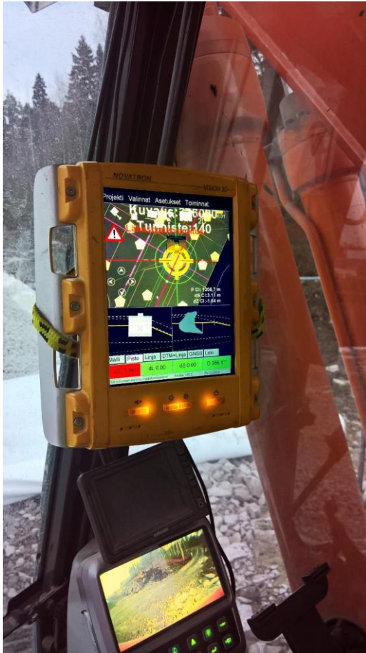
Kuvio 13. 3D-koneohjausjärjestelmännäyttö kaivinkoneessa (Laukkanen 2017)
