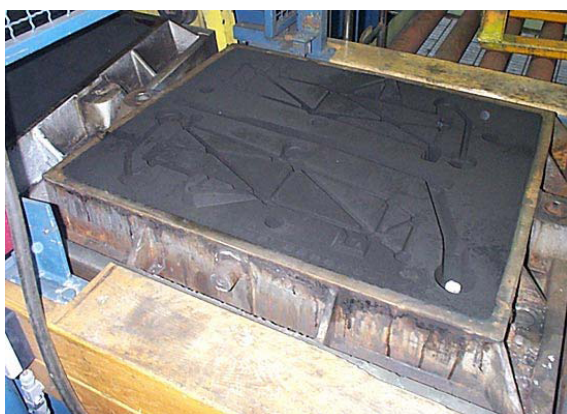
Kuva 4. Muotin valukanavistoon on laitettu ympäysnappi, joka näkyy muotin oikeassa alakulmassa. Ympäysnappi sijaitsee valukanavan pohjan kohdalla. [2, s. 8.]
