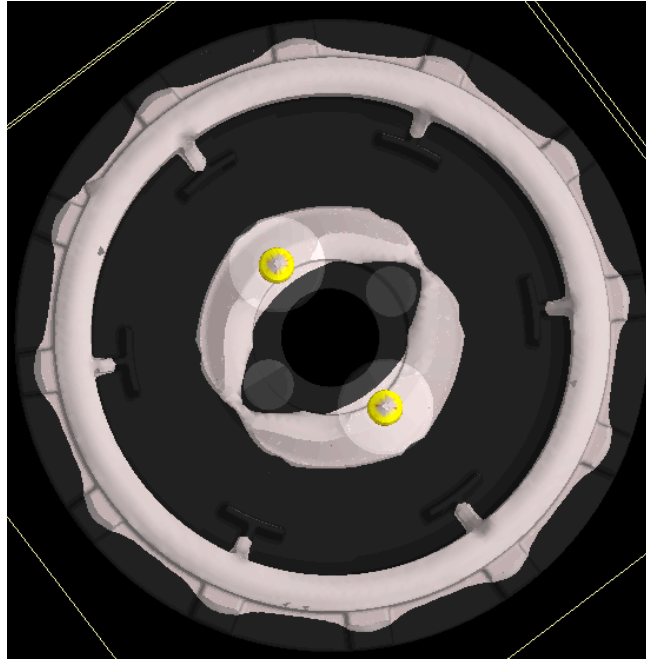
Kuva 32. Kuvakaappaus simuloinnista kahdella eksotermisellä syöttökuvulla ja kahdella kokillilla. Kuvan keskellä olevat keltaiset ympyrät ovat eksotermisiä syöttöjä ja vaaleat ympyrät kokilleja.
