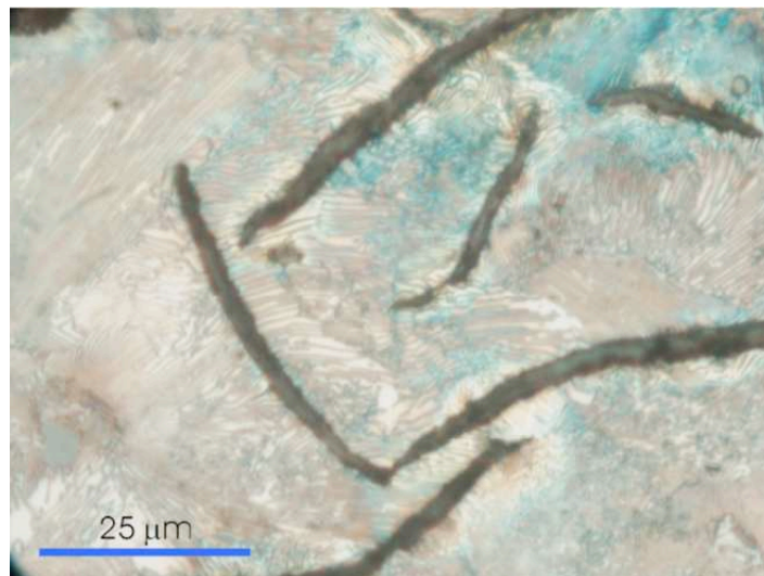
Kuva 14. Mikroskooppikuva suomugrafiittivaluraudan rakenteesta, jossa grafiittisulkeumat näkyvät mustina suomuina perliittisessä perusaineessa [4.].
