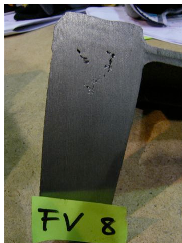
Kuva 6. Valukappaleessa olevaa imuhuokoisuutta, suurempien makroimuhuokosten koko noin 2 mm, alempana olevat mikroimuhuokokset noin 0,2 - 0,5 mm. Kuvan kappaletta on sahattu kriittisistä kohdista laaduntarkkailua varten. Componenta valimo A.
