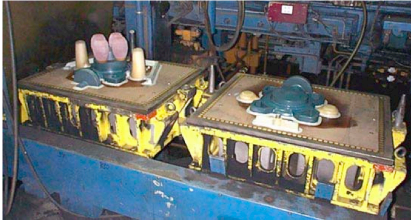
Kuva 8. Mallit odottavat mallivarastossa siirtämistä automaattikaavauslinjan kaavauskoneeseen. Vasemmalla malli muotin yläpuoliskoa varten, huomionarvoisia ovat malliin kiinnitetyt ja muottiin jäävät neljä punaista eksotermista syöttökupua. Oikealla malli alapuolista muottia varten. [2, s. 25.]
