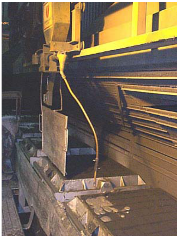
Kuva 3. Kuvassa on automaattikaavauslinjalla valutapahtuman aikana elvytysympäykseen käytettävä suutin, kuva otettu kaadon jälkeen [2, s. 8.]
