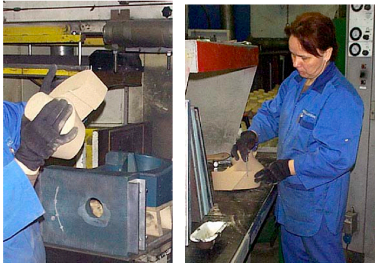
Kuva 12. Vasemmalla valmiin keernan nosto keernatykistä ja oikealla jakopintapurseiden poisto [2, s. 31]
