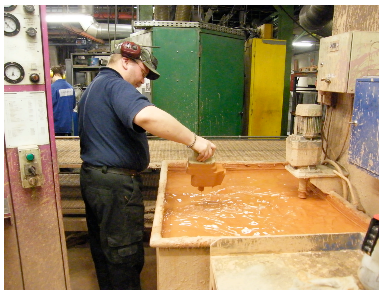
Kuva 13. Keerna kastetaan peitosteaineeseen ja asetetaan takana näkyvälle hihnalle, joka kuljettaa peitostetut keernat uuniin kuivumaan. Componenta valimo A.
