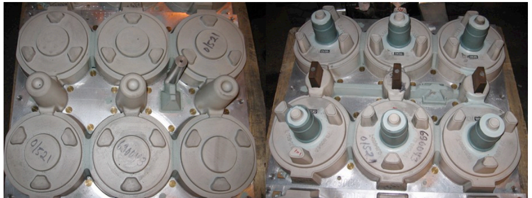
Kuva 34. Vasemmalla on kuva planeetankannattimen nykyisen muotin ylämallista, oikealla muotin alamallista. Malleista ilmenee myös kappaleen valujärjestelmän konstruktio. Kappaleiden välissä kolme luonnollista syöttökupua. Componenta valimo B.
