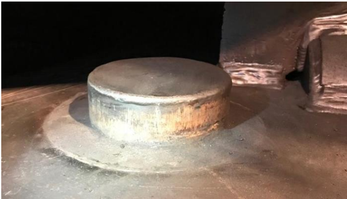
Kuva 13. Paineasetelmassa olevan jousen kiinnitystappi.
