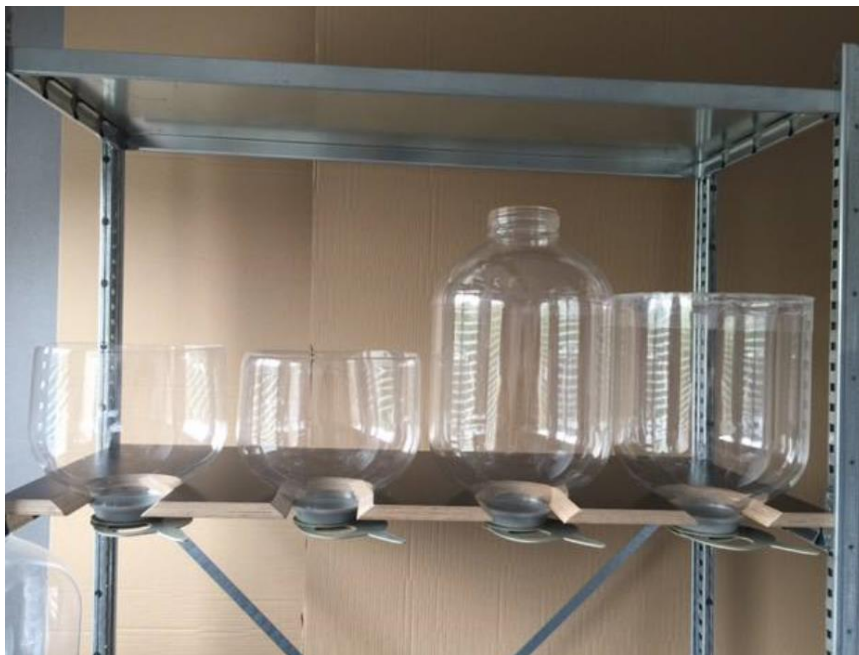
Figure 7. Gravity bins of Coöperatie de Nieuwe Graanschuur market (Coöperatie de Nieuwe Graanschuur market 2017)
