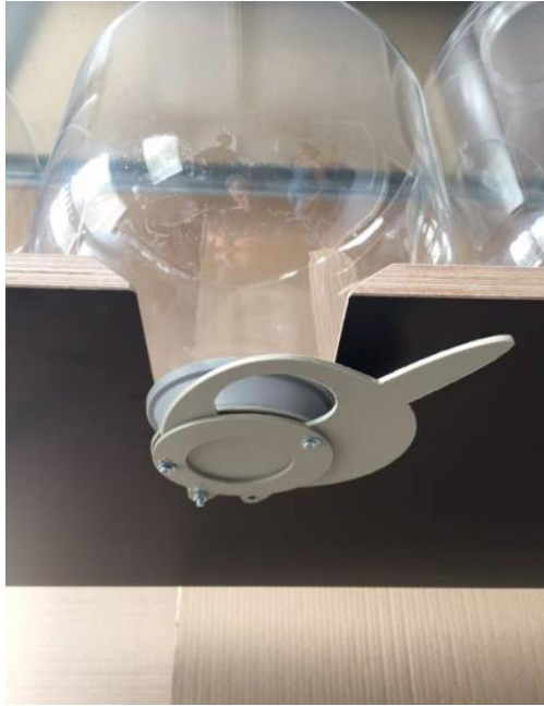
Figure 8. Release mechanism of the gravity bin (Coöperatie de Nieuwe Graanschuur market 2017)
