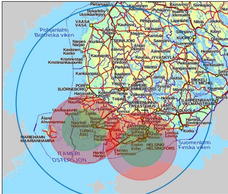
Kuva 21. Esimerkki luuppiantennin ja kahden piiska-antennin peittoalueista sekä katvealueista.
