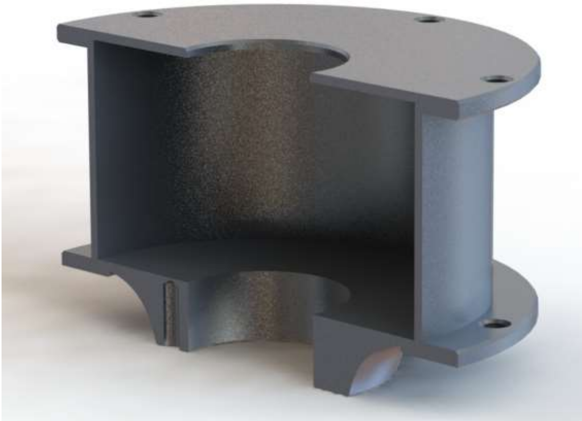
KUVA 16. Absorboivan elementin prototyypin leikkauskuva sivusta tarkasteltuna
