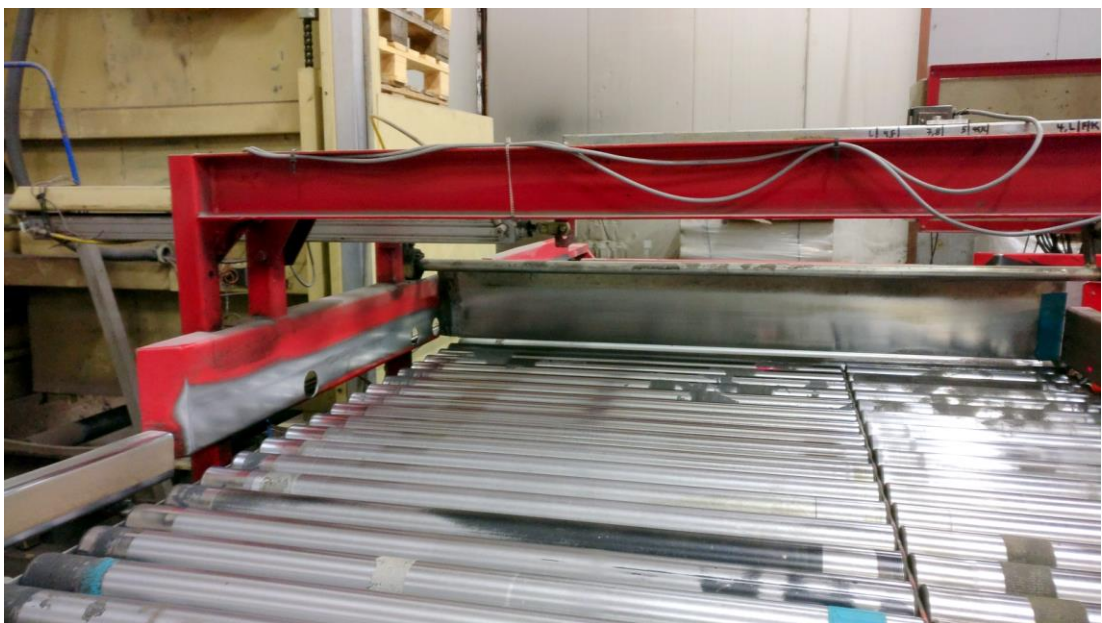
Kuva 23. Paineilmasylinterimellä toimiva siirrin ja rullakuljetin
