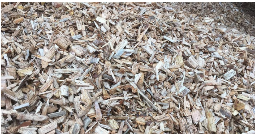
Kuva 1. Maaseutuyrityksen lämpökeskuksen hakevarastossa pitää olla tarkkana. Hakkeesta muodostuu ilmaan häkää ja heksanaalia. (Kuva: Risto Lauhanen.)
