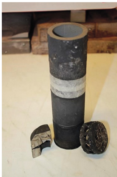
Kuva 31. Polttoilmasuutin, josta on leikattu pää pois näytteenvalmistusta varten.
