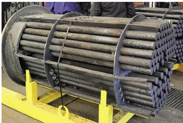
Kuva 26. X8CrNi25-20 (EN 1.4845) – teräksestä tehty lämmönvaihdin.
