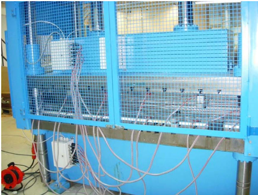
Kuva 25. Uudet lisälämmityslevyt ohjausyksikköineen prässissä.
