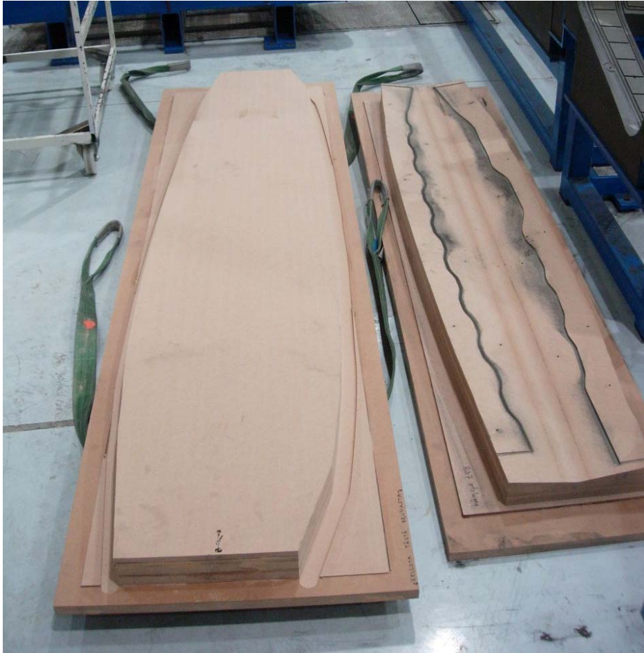
Kuva 30. Rib 7 C-web ja Foot koneistuskiinnittimet.
