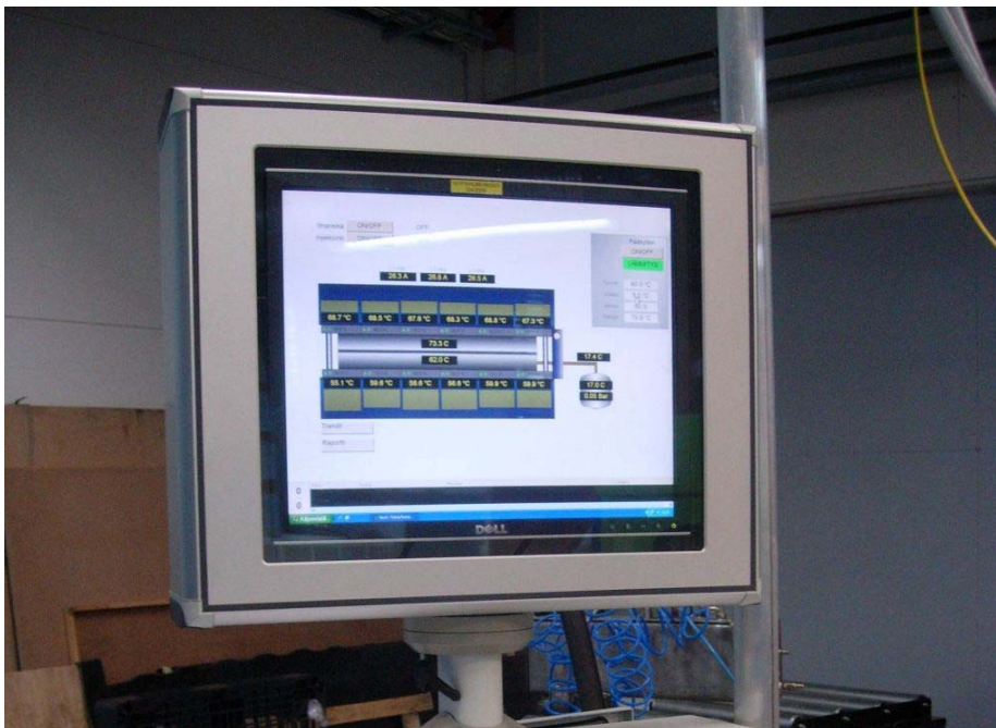
Kuva 26. Lisälämmityslevyjen uusi ohjausohjelmisto.
