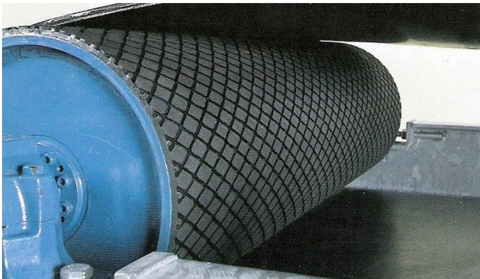
Kuva 3.6 Kumi päällysteinen Veturummu (Metso minerals esite 2009).
