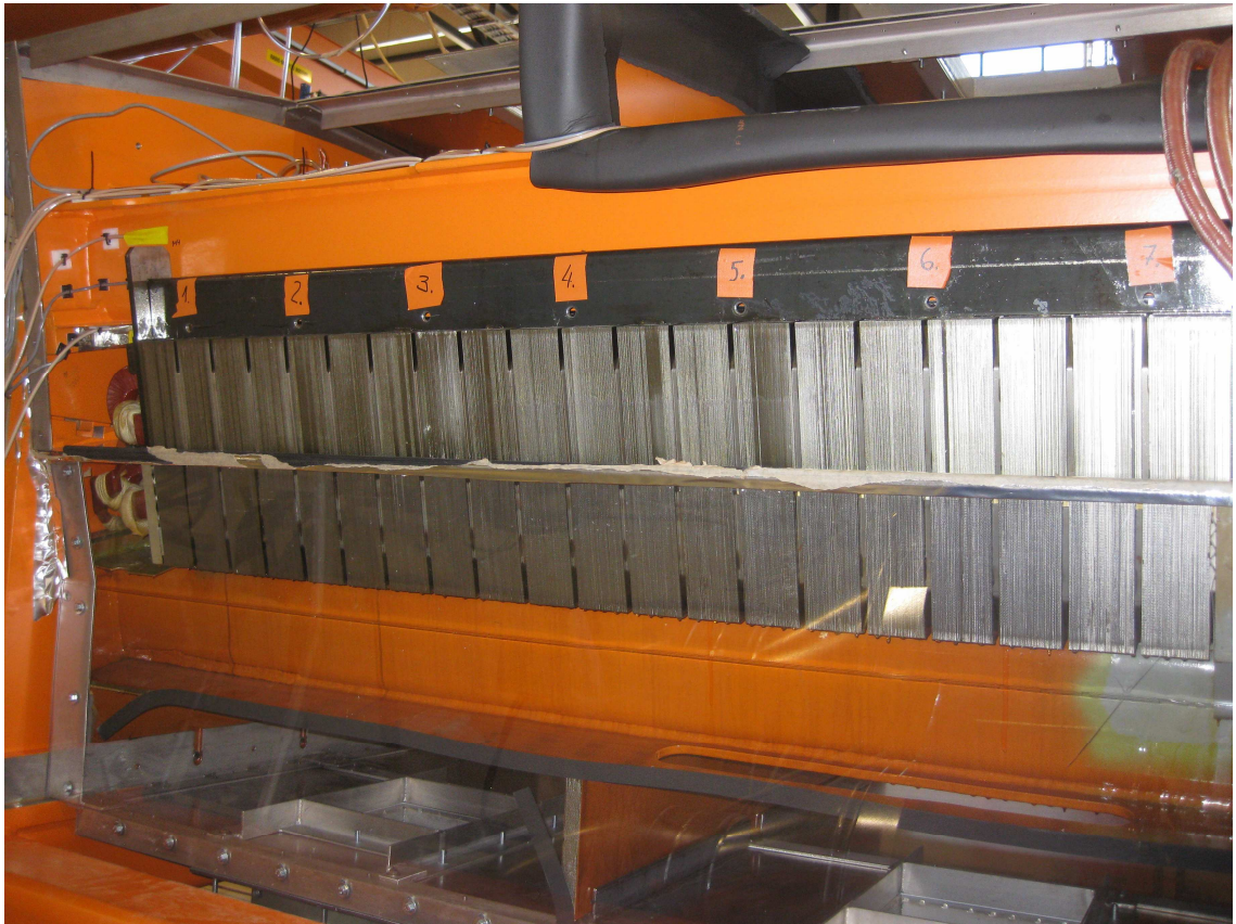
Kuva 7 Staattori- ja roottorisegmentit päällekkäin
