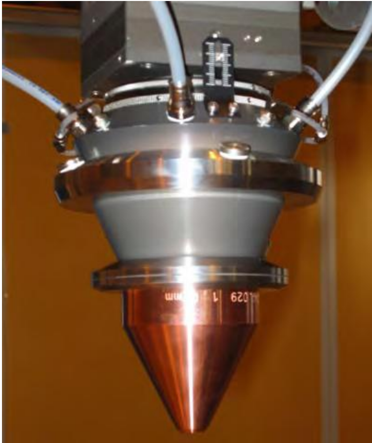
KUVIO 6. Koaksiaalipinnoituspää (LASERCO 2010.)
