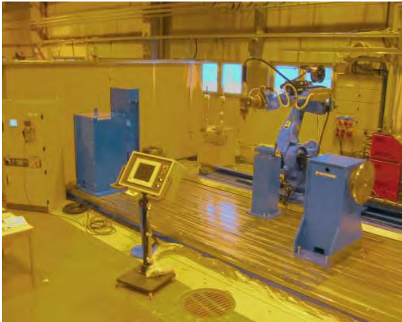
KUVIO 4. Nd:YAG-robottityöasema (Laserco 2010.)
