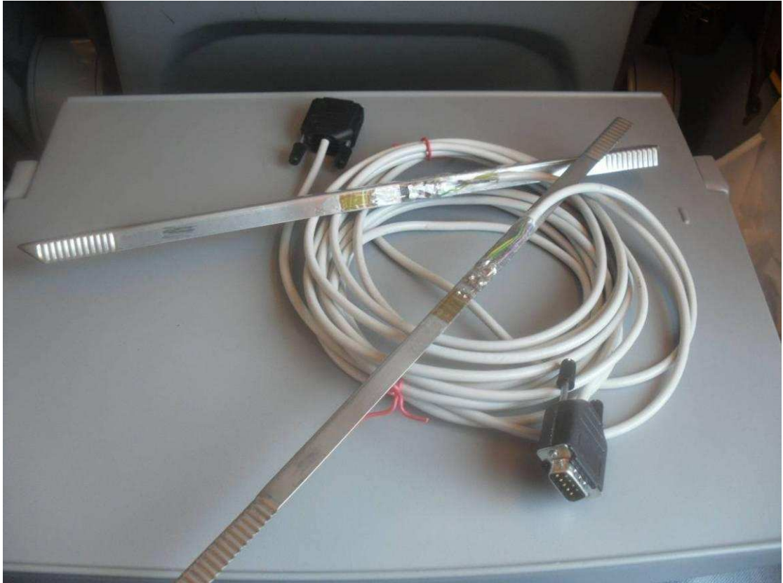
Kuva 6.5. Venymäliuskat asennettuna ansaisiin
