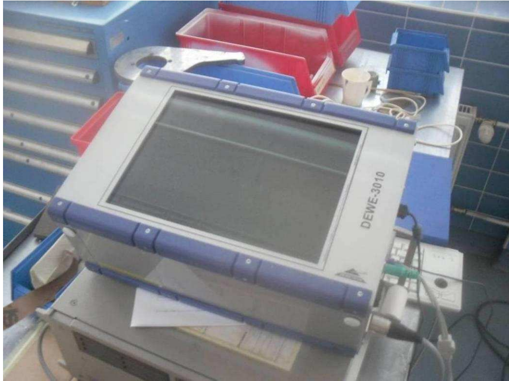
Kuva 6.4 Venymäliuskojen mittausyksikkö DEWE-3010
