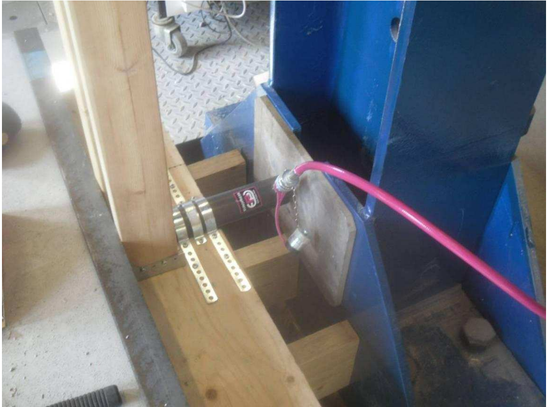
Kuva 6.18. Tunkki kiinnitettynä ja valmiina koestukseen
