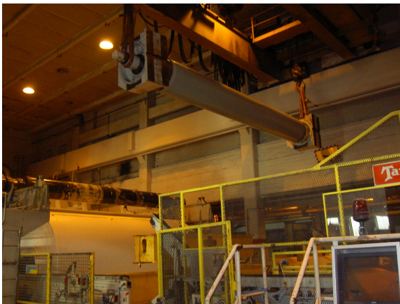
Kuva 23. Vanhan telan poisto
