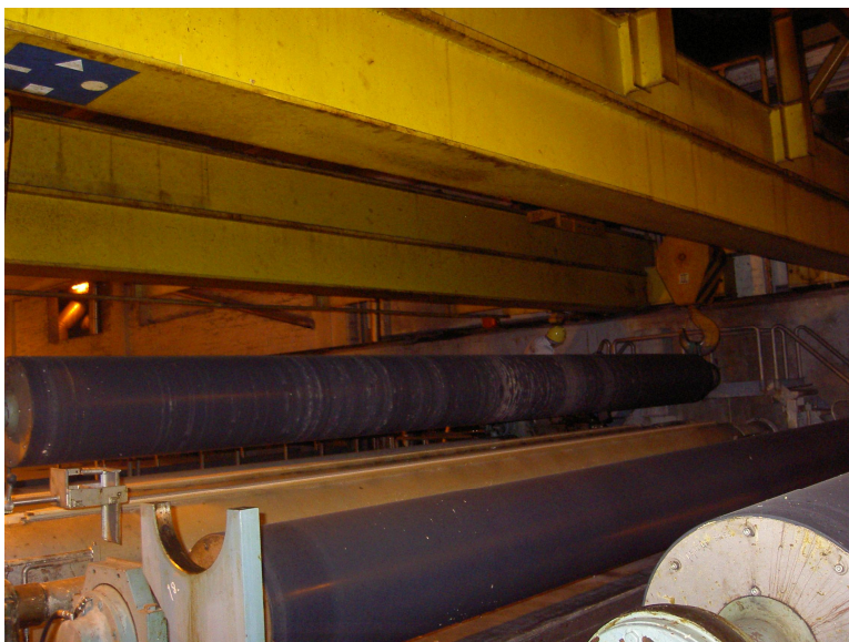
Kuva 14. Telan liikuttelua nosturilla ahtaissa tiloissa
