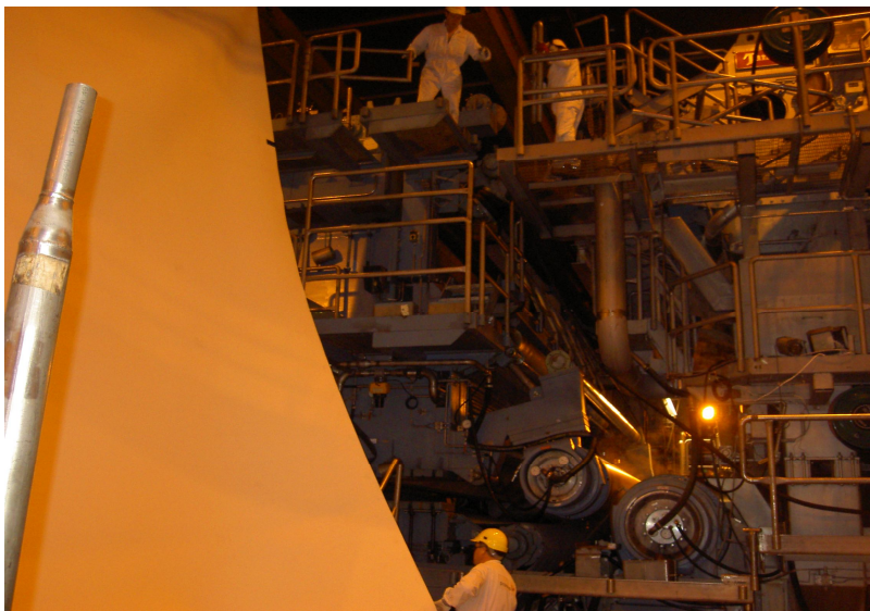
Kuva 17. Huovan pujottaminen koneeseen
