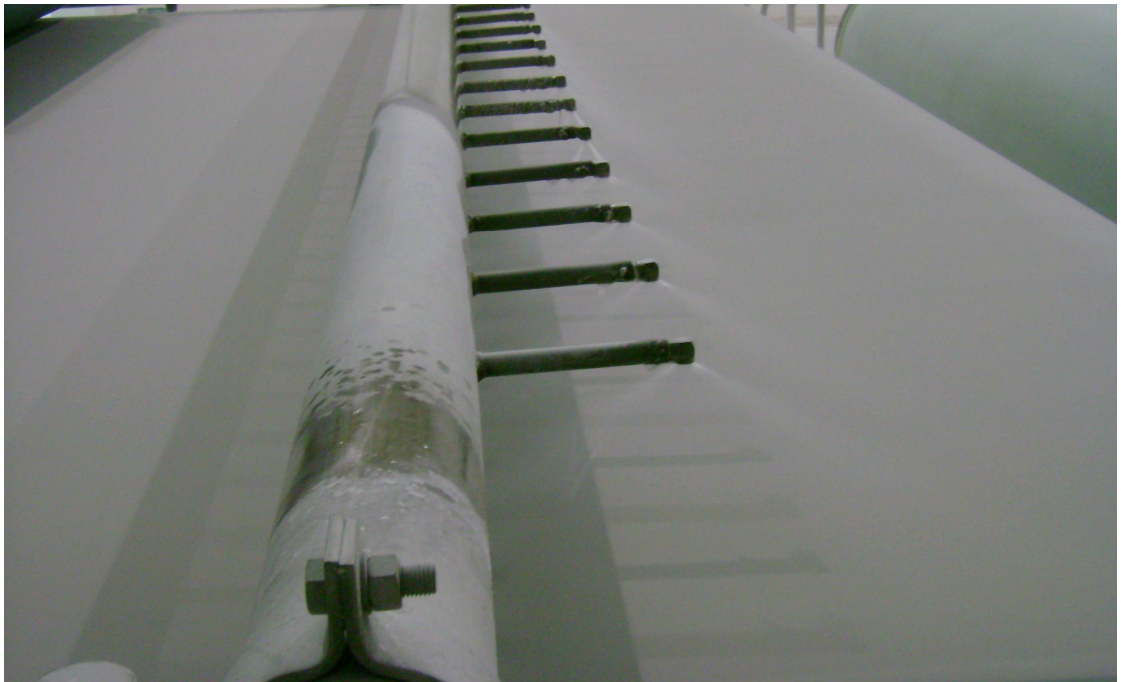
KUVIO 12. Likakertymiä tärkkelyssuihkuputken pinnalla (Partanen 2007b)
