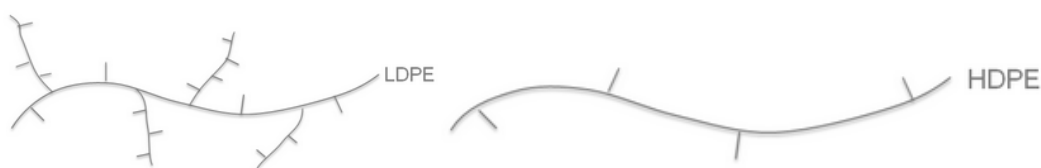
KUVIO 12. LDPE:n ja HDPE:n haaroittuneisuus (Polymer Properties Database 2015a, muokattu)
