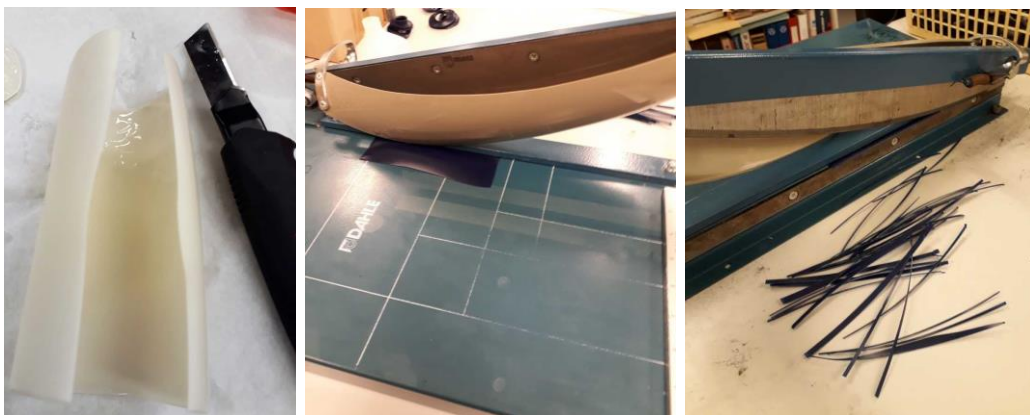
KUVA 1. Pullojen käsittelyä mattopuukolla ja paperileikkurilla
