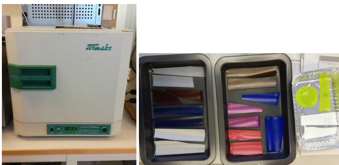
KUVA 10. Termaks TS 8024 -lämpökaappi ja uunivanhennukseen meneviä HDPE-kappaleita
