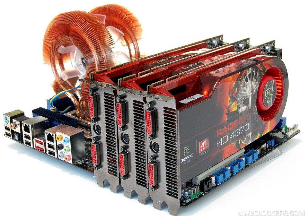
Figur 4.1. Tre stycken ATI Radeon HD4870 grafikkort i en trevägs CrossFire konfiguration. [26]
