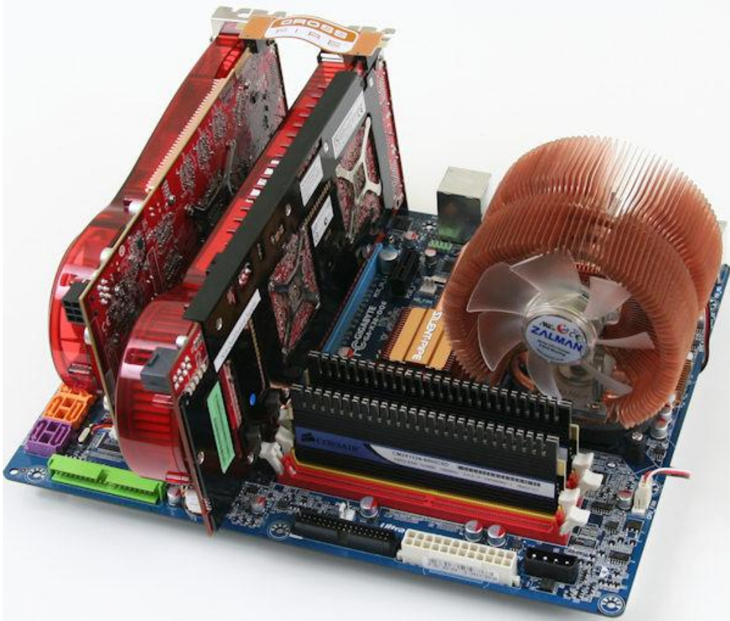
Figur 6.3. Ett st Radeon HD 3870 och ett st Radeon HD 3870 X2 CrossFire kopplade. [14]
