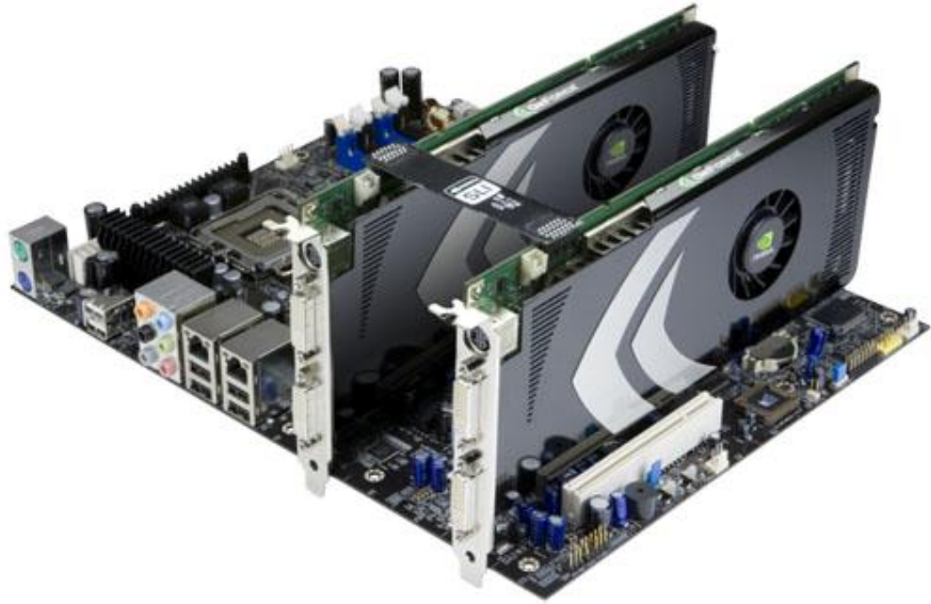
Figur 3.1. Två stycken Geforce 8800 GT grafikkort kopplade i SLI med SLI-bryggan mellan korten. [23]
