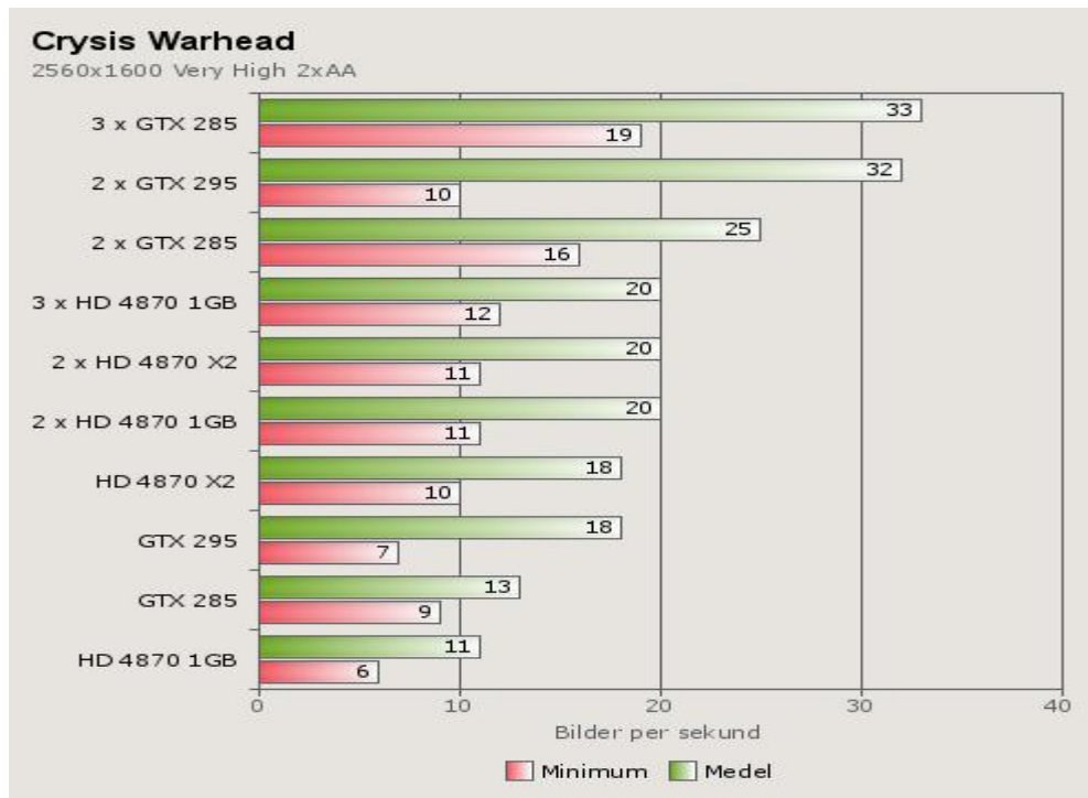
Figur 11.19. Crysis Warhead resultat med resolutionen 2560x1600. [26]
