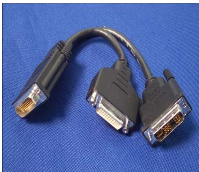
Figur 6.1. DMS-59 kabel för CrossFire.
