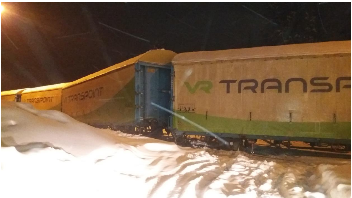
Kuva 3. Suistuneita tavaravaunuja ratapihalla. (Kuva: Janne Lappalainen)
