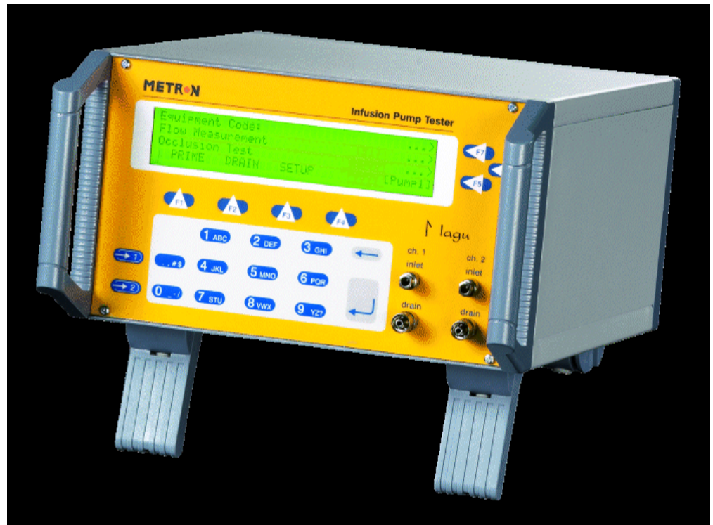
Kuva 4. Infuusiopumpputesteri QA-IDS/Metron lagu.
