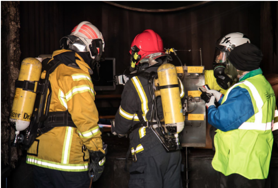
KUVA 3. Konttipalon savukaasujen näytekeraäys (kuva Eloaho 2018)
