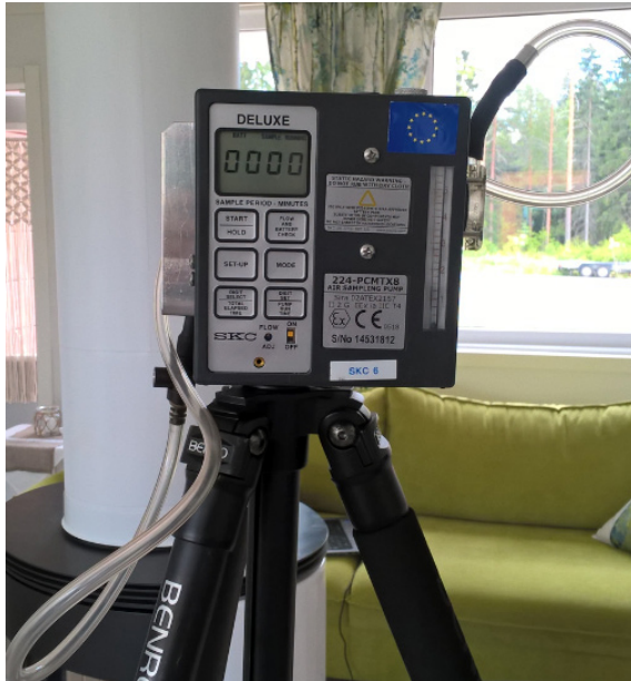
KUVA 1. Näytteenotto pumpulla Tenax TA -adsorbenttiputkeen
