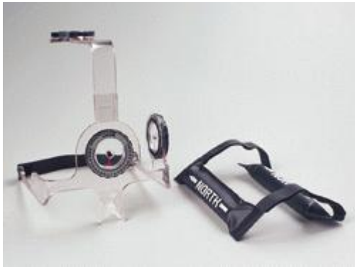
KUVA 3. CROM-laite sekä kaulalle asetettava magneettivyö. (Lähde: http://www.pmtionline.com/graphics/242.jpg )
