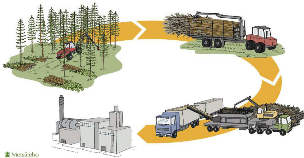
KUVIO 6. Pienpuuhakkeen tuotantoketju tienvarsihaketuksessa, erillisellä hakkurilla ja hake-autolla (Metla 2008).
