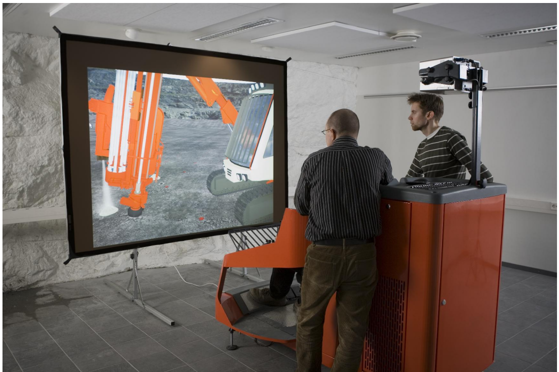
Kuva 2: Poravaunusimulaattori SimDriller (lähde: Sandvik Mining and Construction)
