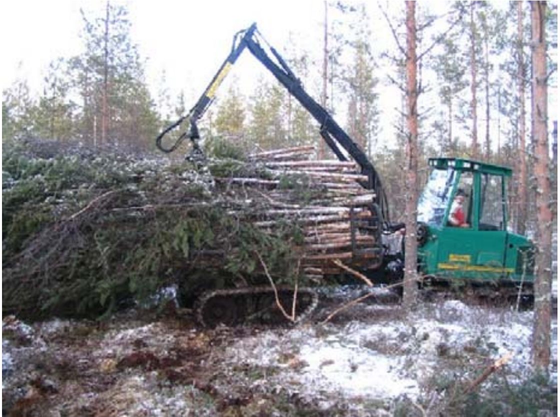
KUVIO 12. Logbear metsäkuljetusvarustuksessa ajamassa karsimatonta energiapuuta.
