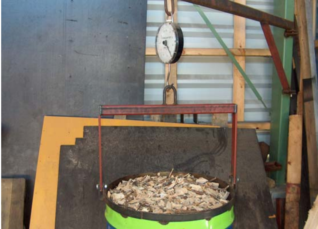
KUVIO 5. Hakevaraston nurkassa olevalla vaa'alla punnittiin irtokuutiopainot
