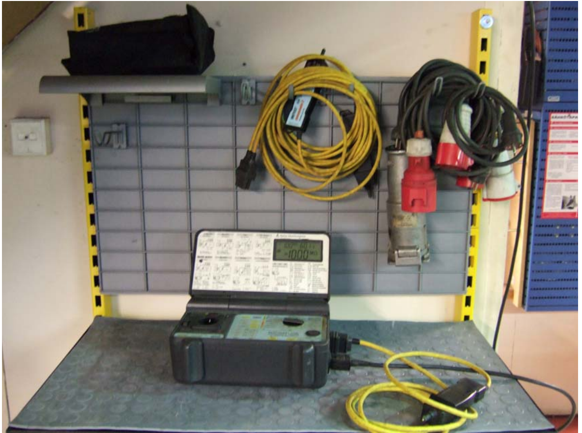
Kuva 13. Käsityökalujen ja muiden koneiden turvallisuusmittauspiste
