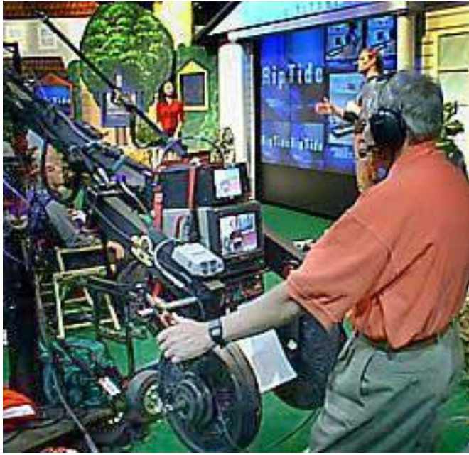
KUVA 2. Kameran tukivarren toinen pää, josta ohjataan kraania (Whittaker 2010)
