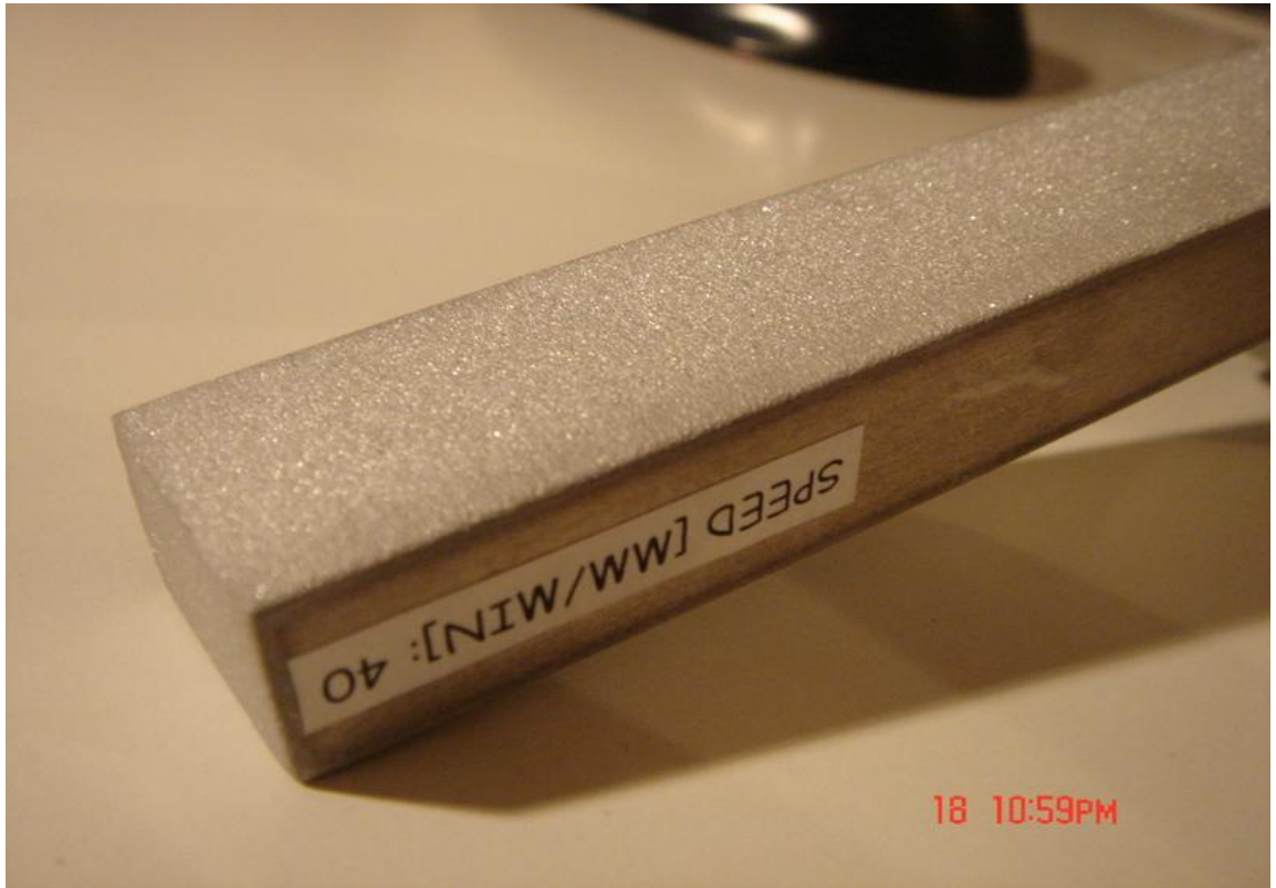
Kuva 8.2 Vesileikkausjälki nopeudella 40mm/min.
