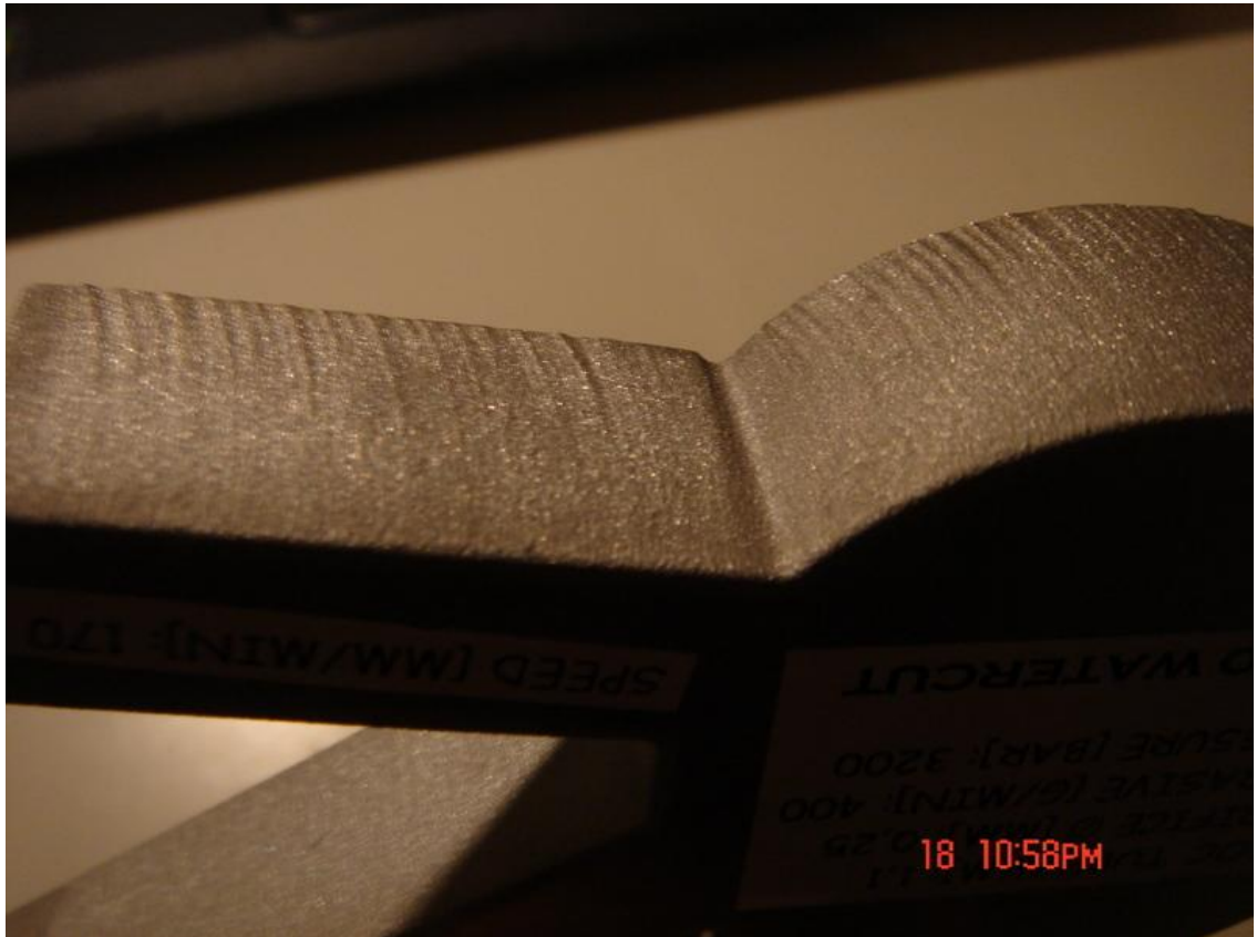
Kuva 8.4 Vesileikkausjälki nopeudella 170mm/min.
