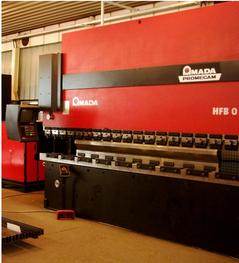
Kuva 3.2 Käytössä oleva Amada HFT 220- 3 särmäyspuristin.
