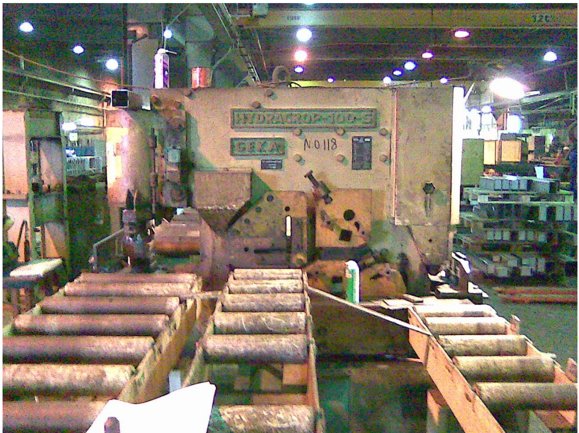
Kuva 3.5 Sahauslinjaston lävistin ja kulmanpoistolaite, lävistin vasemmalla puolella ja kulmanpoistaja oikealla.
