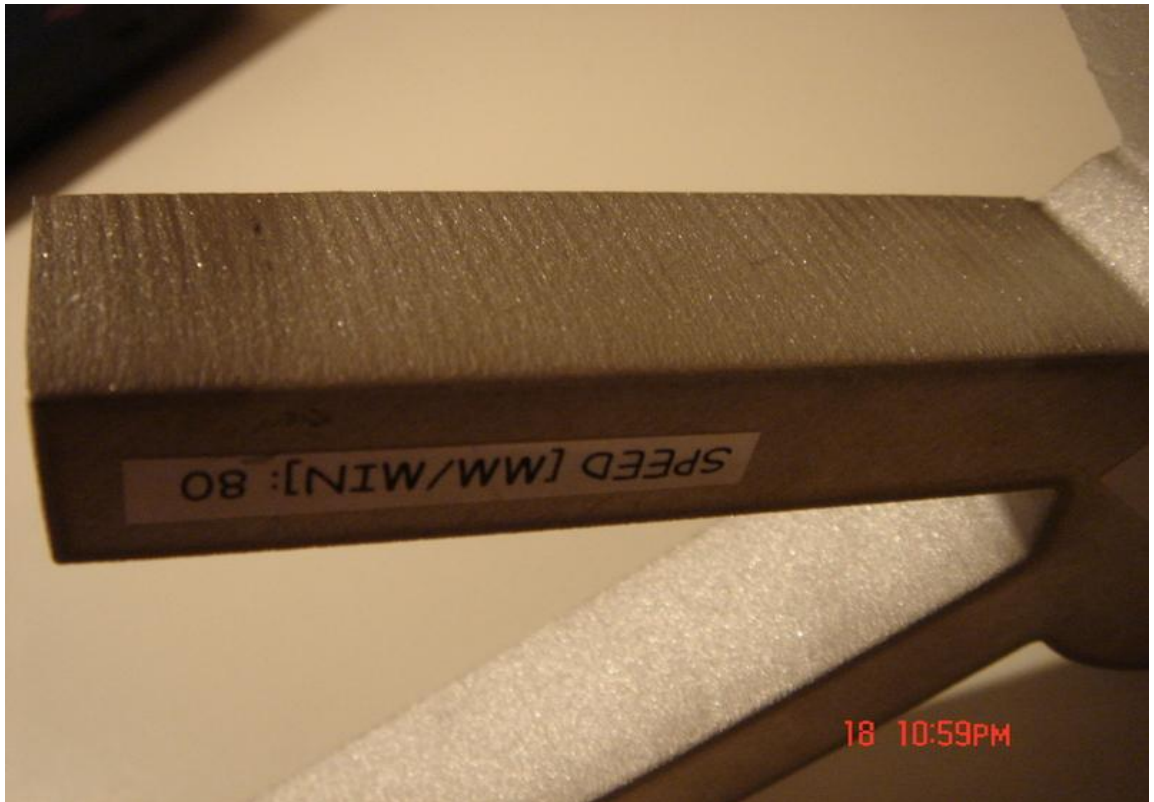
Kuva 8.3 Vesileikkausjälki nopeudella 80mm/min.
