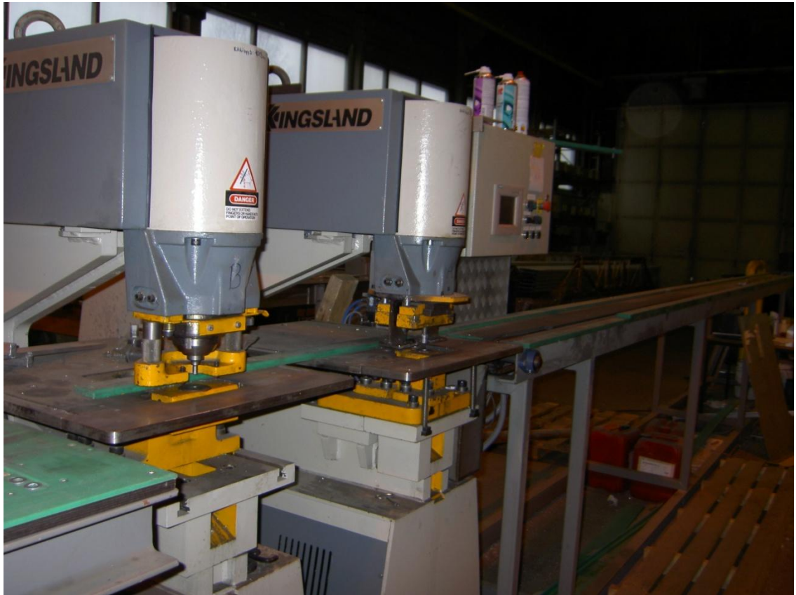
Kuva 7.1 Alumiinisten hoitotasojen osastolla toimiva lävistinlinja.
