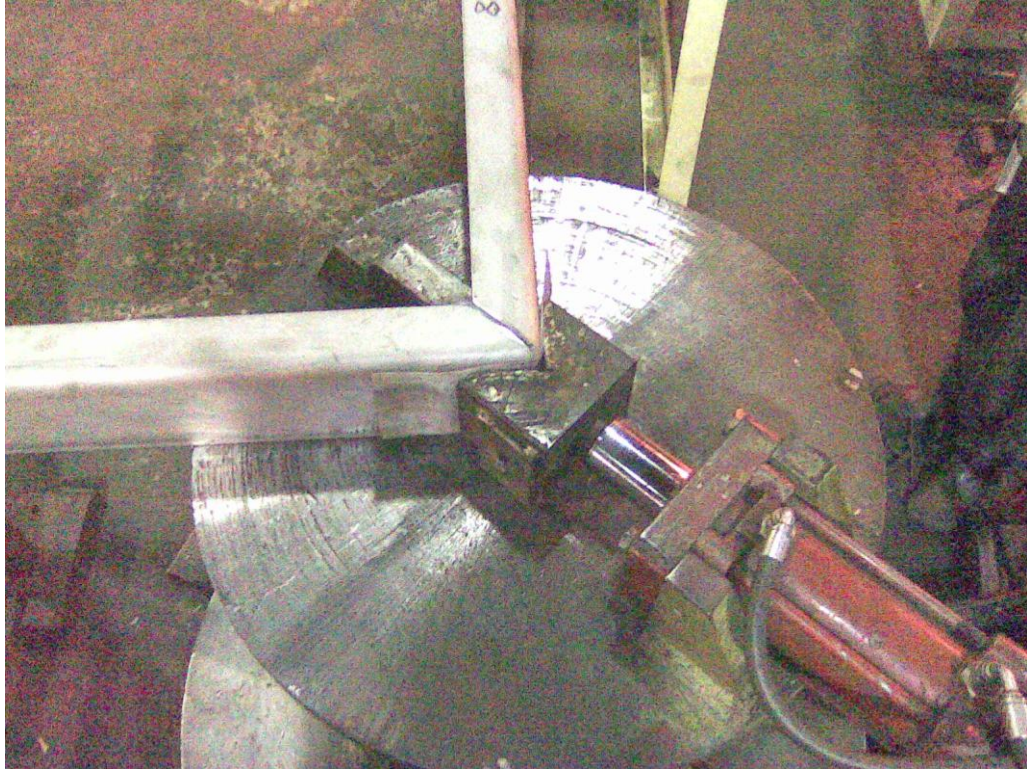
Kuva 3.6 Kulmaprofiilien taivuttamiseen käytettävä hydraulitaivutin.
