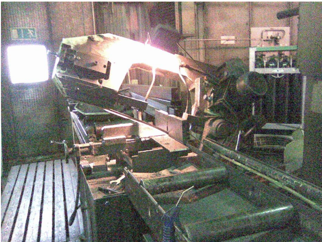
Kuva 3.4 Käytössä esivalmistuslinjaston vannesaha.
