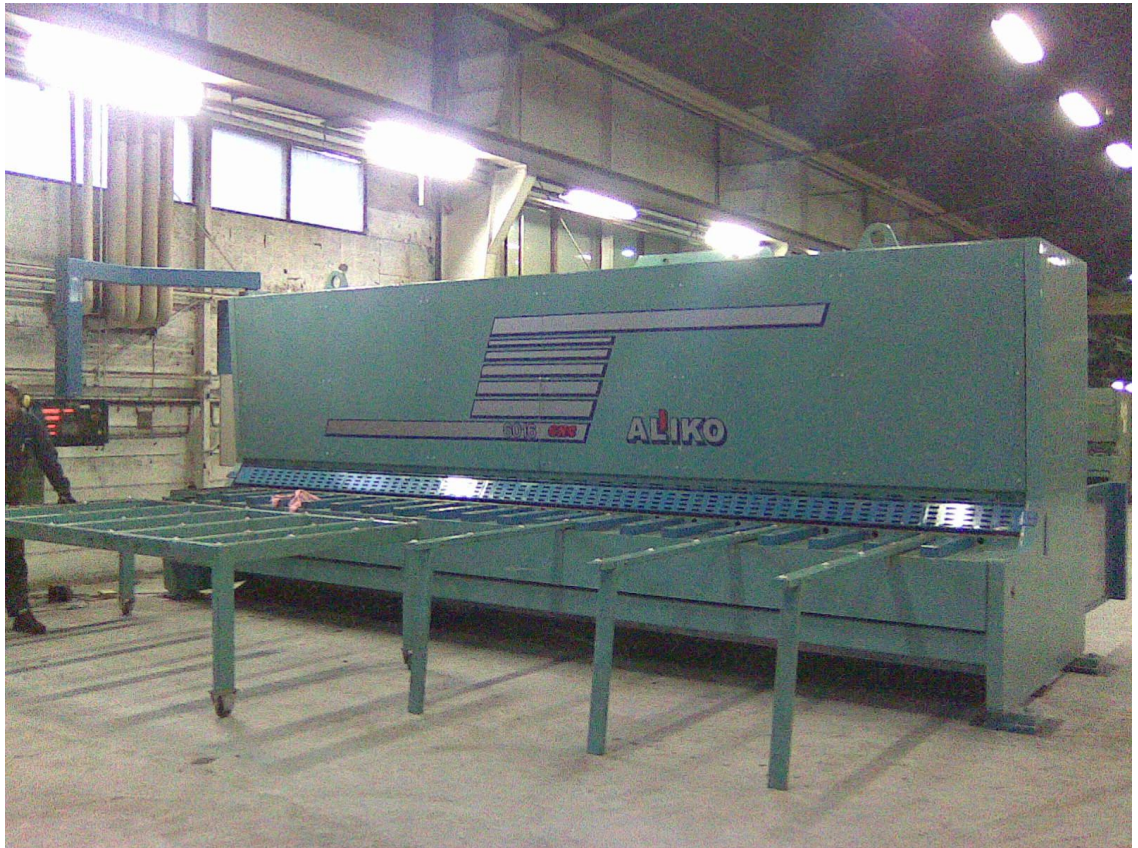
Kuva 6.1 Alikon 6016 6 metriä leveä levyleikkuri.
