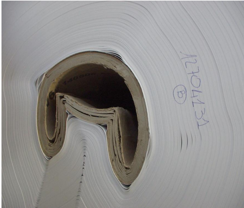
Kuva 5 Trukkikäsitellyssä pudonneen rullan pääty (Leskinen 2009)
