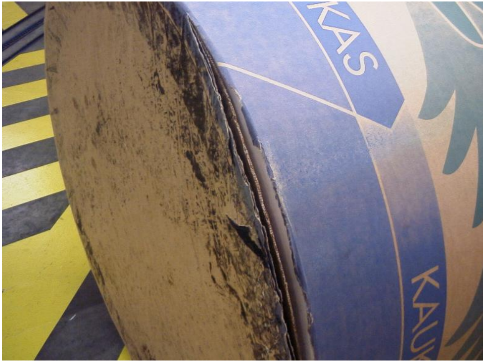
Kuva 4 Päätyvaurioitunut rulla (Leskinen 2009)
