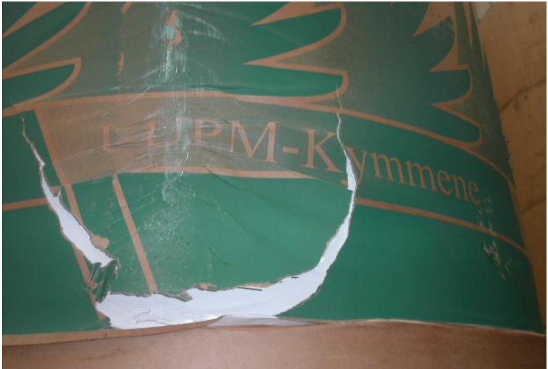
Kuva 3 Kulmavaurioitunut rulla (Leskinen 2009)
