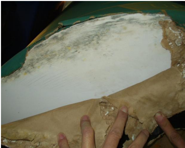
Kuva 7 Kastuneen rullan pohja kääreen sisältä (Leskinen 2009)
