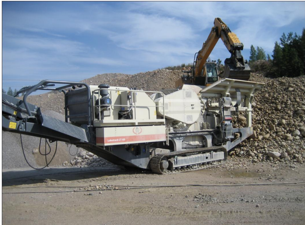
Kuvio 4: LT106 Lokotrack tela-alustainen liikkuva murskainyksikkö /2/
