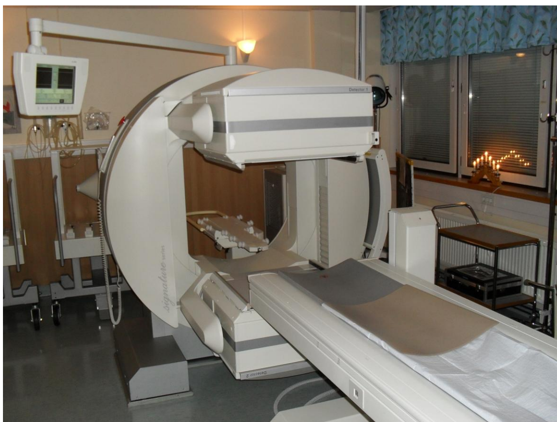
KUVIO 3. Virtsan refluksen gammakuvauksessa käytettävä gammakamera
