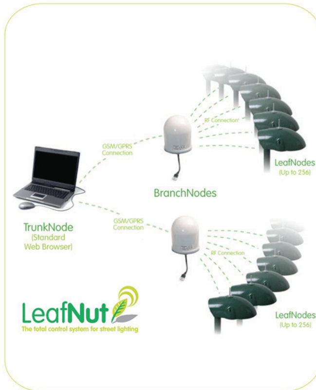
KUVIO 31. LeafNut-ohjausjärjestelmän rakenne (Harvard Engineering 2010.)
