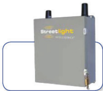
KUVIO 28. Lumen IQ Station-kommunikaatiomoduuli (Streetlight Intelligence Ltd. 2010.)
