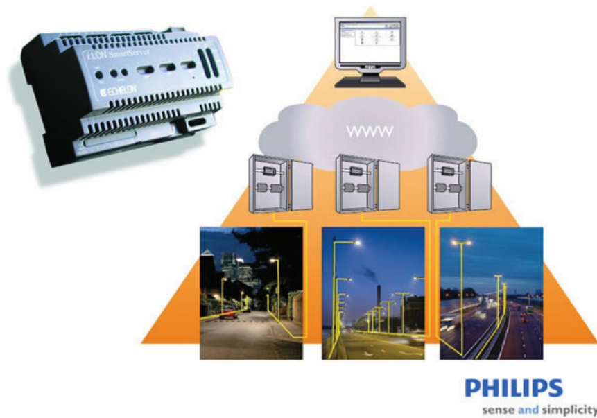
KUVIO 24. Philips Starsense Management-ohjausjärjestelmän rakenne (Philips Lighting 2010.)
