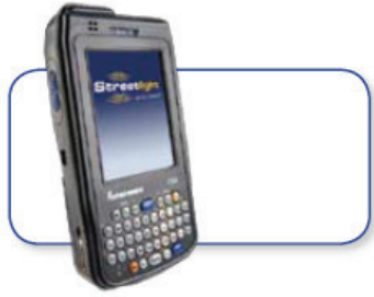
KUVIO 30. Lumen IQ Commander-ohjelmointilaitte (Streetlight Intelligence Ltd. 2010.)
