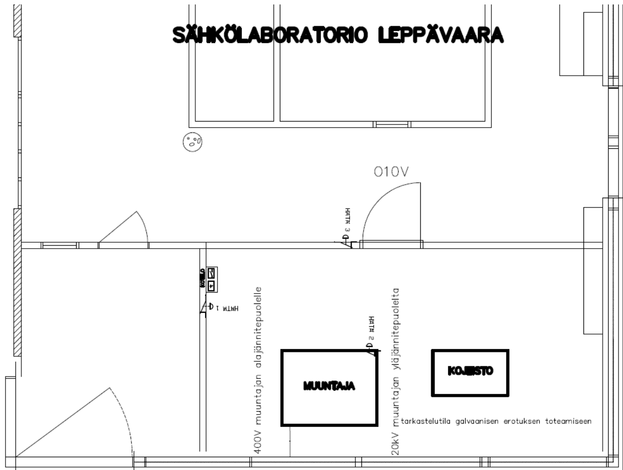
Kuva 22. Pääkytkimen ja kolmen hätä-seis-painikkeen sijoittuminen tilaan
