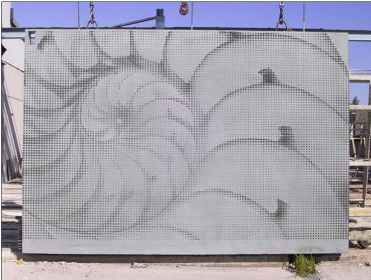
Kuva 1. Graafista betonia betonielementissä
