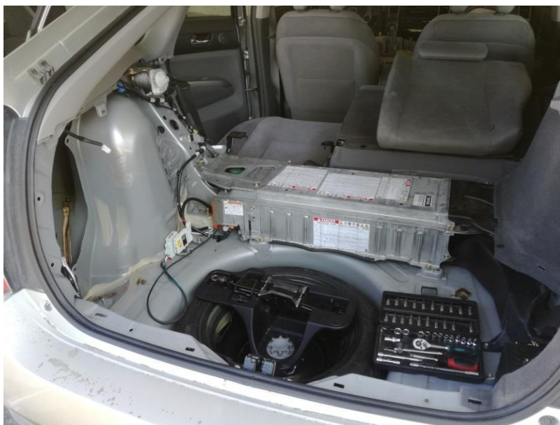
Kuva 7. Verhoilupaneelit ja selkänoja irrotettuna
