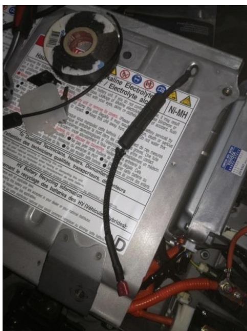
Kuva 11. Syöttöjohto järjestelmän releelle
