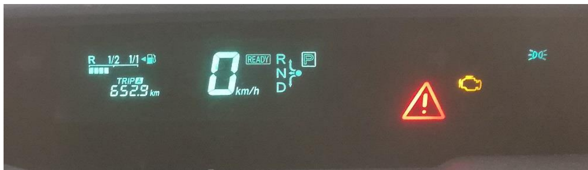
Kuva 18. Mittaristoon palamaan jäävät varoitusvalot
