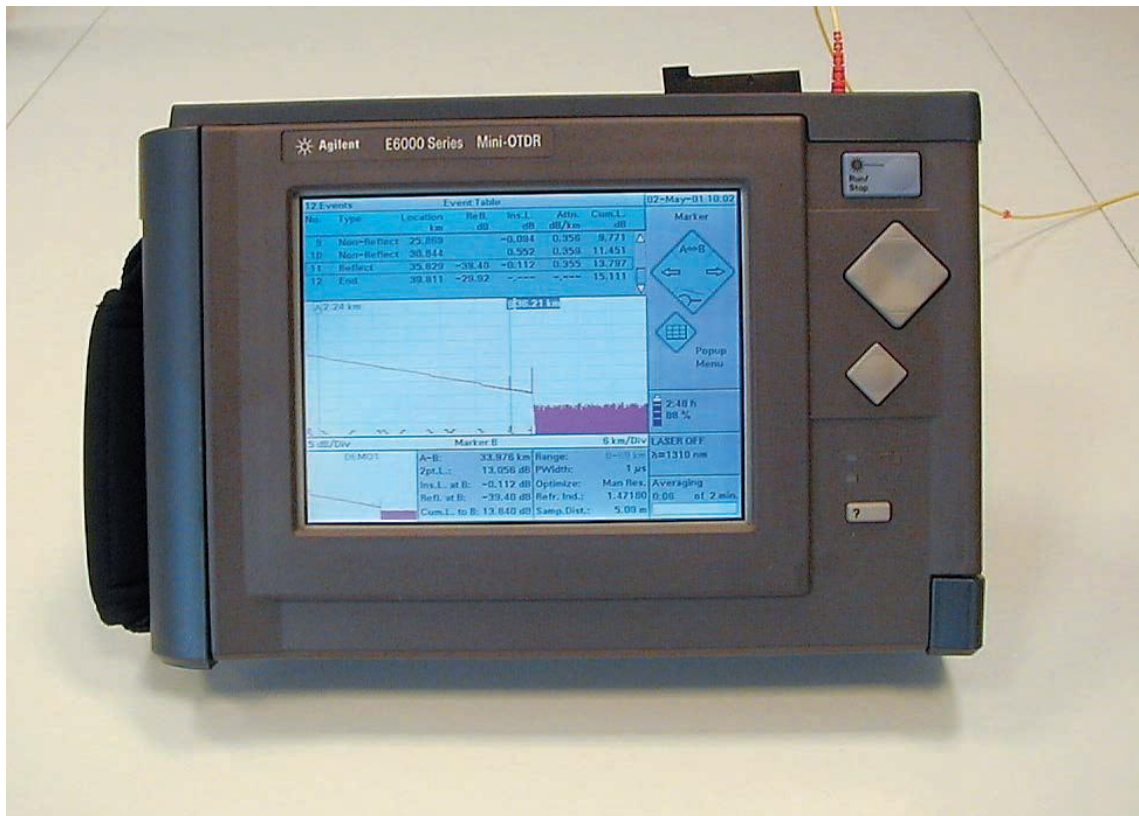
Kuva 5. OTDR eli valokaapelitutka (4, s. 80).
