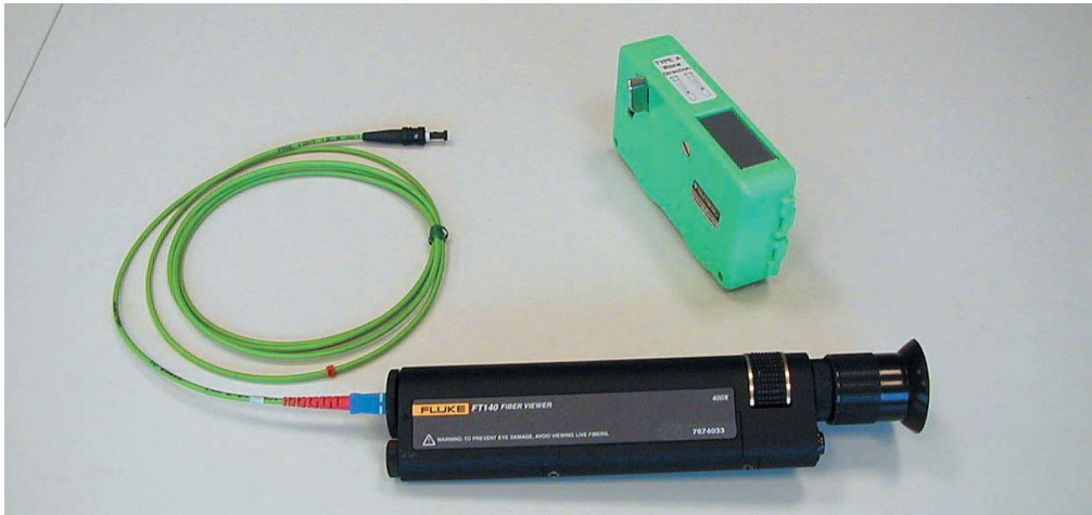
Kuva 2. Kuituliittimen tarkastus -ja puhdistustyökalut (4, s. 83).
