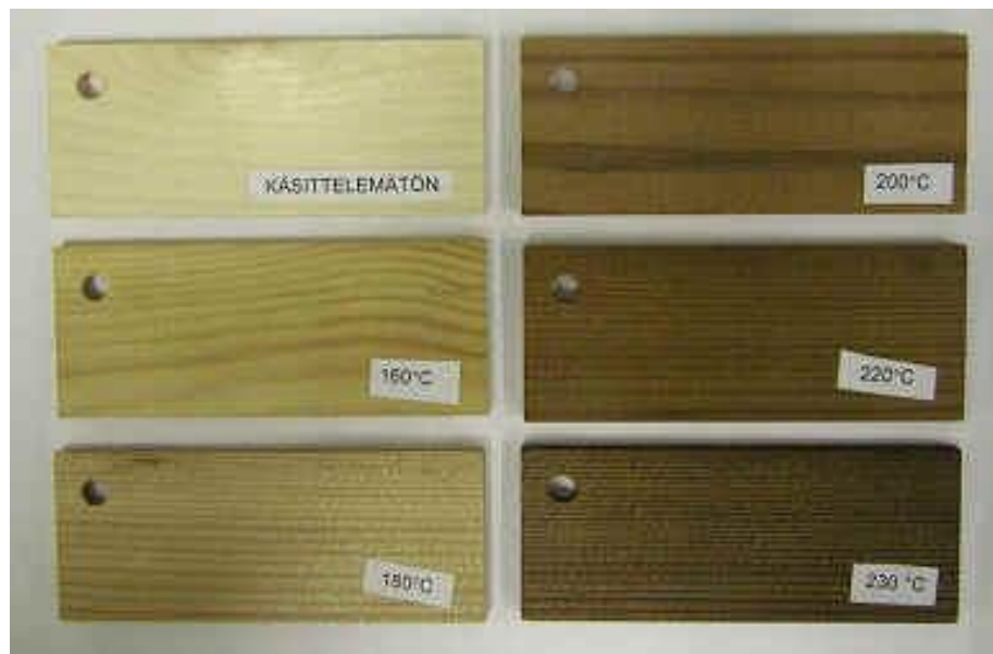
FIGURE 2. Effects of the thermal modification temperature on the final result. (Lämpökäsitellyn puun ominaisuudet ja lujuus, 2002)
