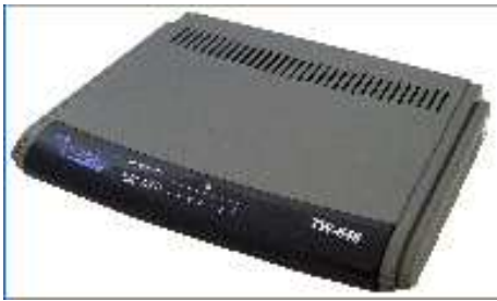
Kuva 12. TW-646 reititin- ja palomuurilaite. /4 /.
