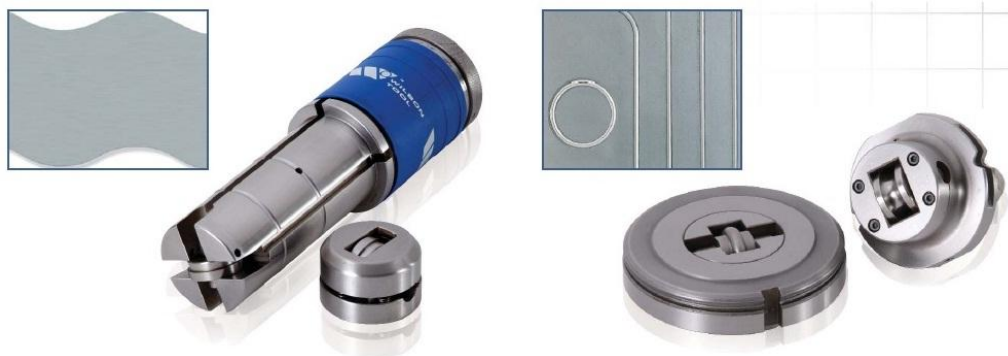
Kuvio 15. Levytyökeskustyökaluja, leikkaus ja muovaus (Wilson Tool Interna- tional®)
