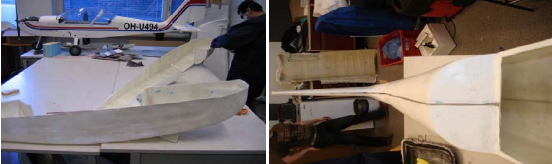
Kuva 44. Rungon vasen ja oikea puoli liimattu yhteen.
