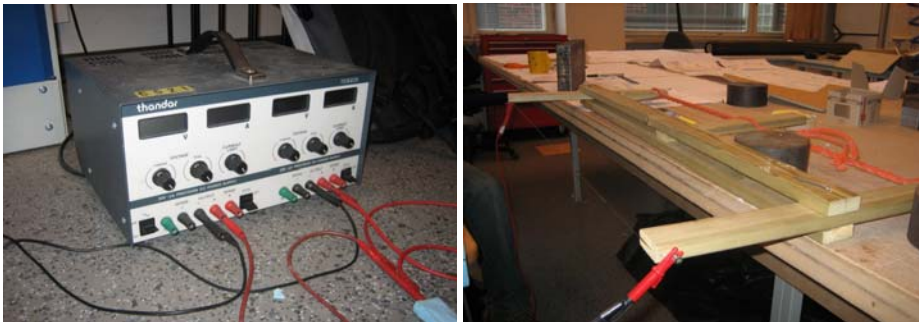
Kuva 42 Tässä laitteessa on kaksi 12 voltin osaa, jotka on kytketty sarjaan. Näin saadaan käyttöön 24 voltia.
