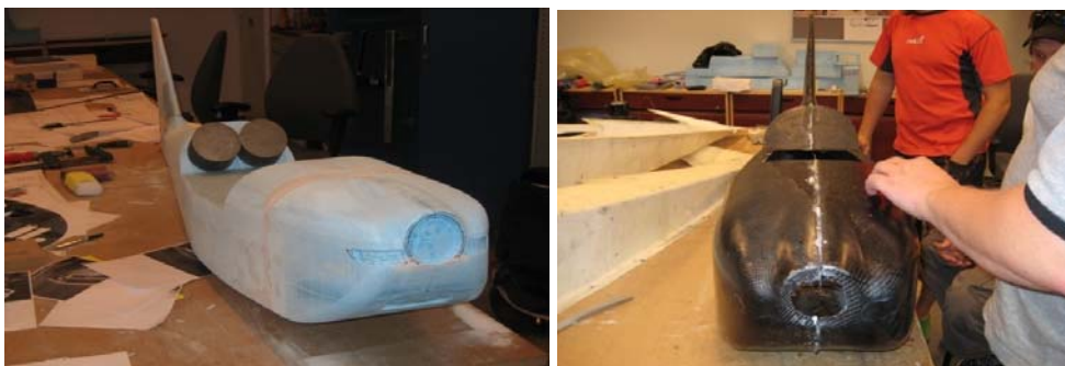
Kuva 43. Rungon muoto foamista ja rungon muotti laminoinnin jälkeen
