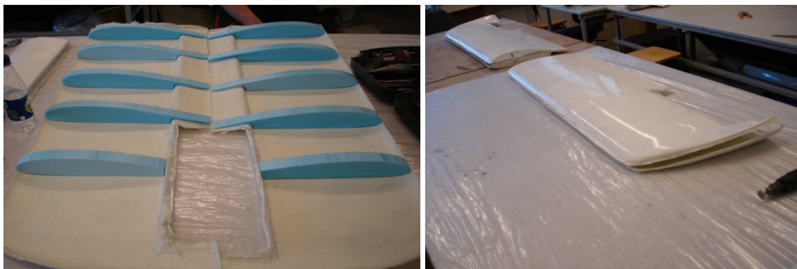
Kuva 48. Siiven kaaret ja yhteenliitetty siipi.
