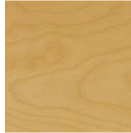
tuvan kiintokalusteet, sorvattu ja vaakasuunnassa kää- netty koivuviilu, öljytty Nostalgia Puuöljy luonnonvärinen
