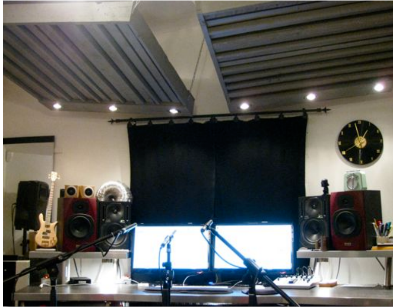
Kuvio 1. UKKOstudion tarkkaamon diffuusorit ja mittamikrofonien asettelu.
